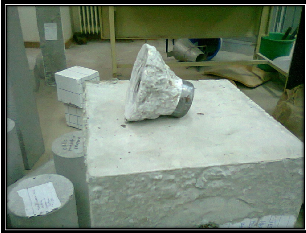
Σχήμα 1.10.11 Η κωνική αστοχία. Σκυρόδεμα πάνω στον ήλο.
