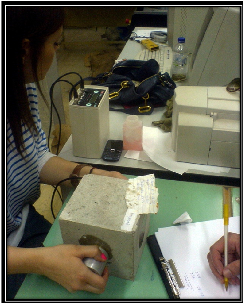
Σχήμα 2.12.5 Τοποθέτηση κεφαλών εκτομής και λήψης και καταγραφή χρόνου T.
