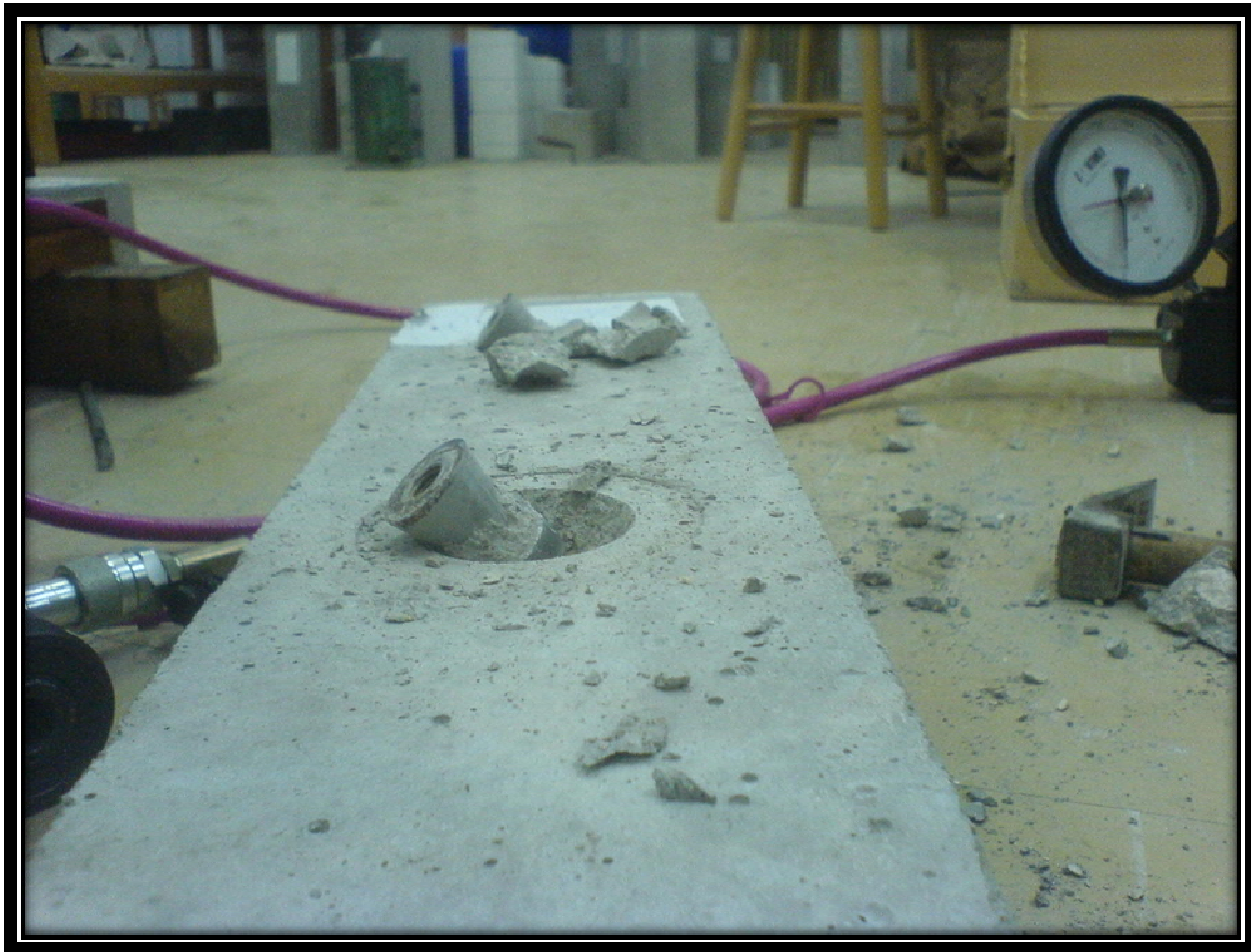
Σχήμα 1.10.8 Ήλοι που έχουν εξολκευθεί στο πρισματικό δοκίμιο.
