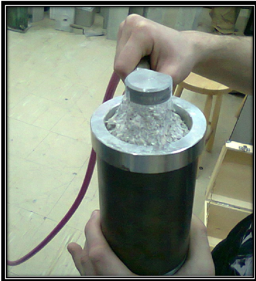
Σχήμα 1.10.10 Η κωνική αστοχία στο σύστημα φόρτισης.
