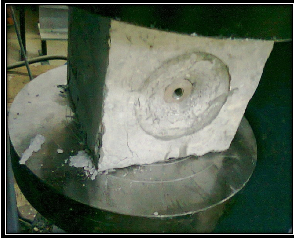
Σχήμα. 1.9.2.2 Δοκίμιο στην μηχανή θλίψης (πρέσα).
