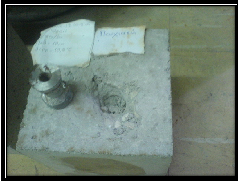
Σχήμα 1.10.1 Ο ήλος εξόλκευσης και το κυβικό δοκίμιο.
