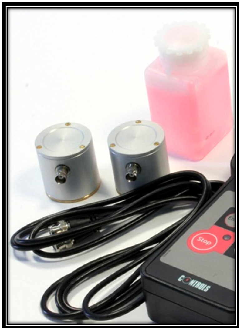
Σχήμα 2.12.2 Λιπαντική ουσία και κεφαλές (Κρύσταλλοι) με τα καλώδια τους.
