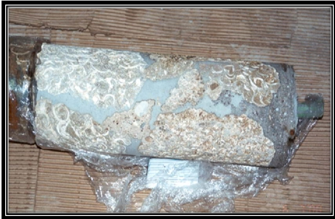
Σχ. 1.1.7 Δοκίμιο από τοιχοποιία στην οποία είχαν γίνει ενέματα ομογενοποίησης μάζας
