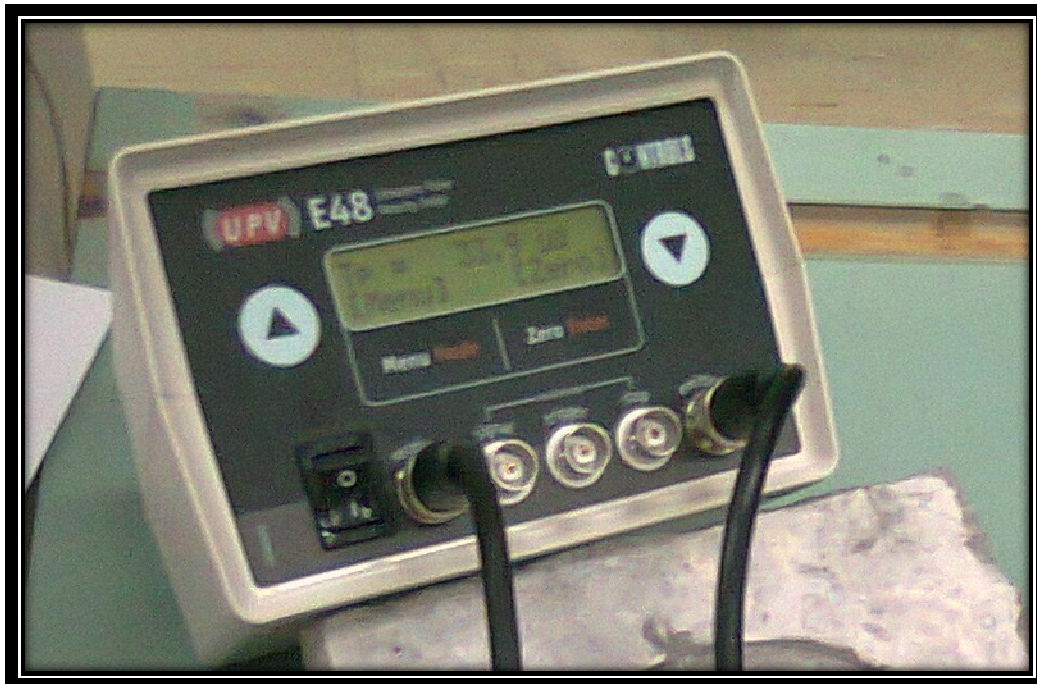
Σχήμα 2.12.1. Γεννήτρια παραγωγής Υπερηχητικών κυμάτων. Παρατηρούμε τις υποδοχές εκπομπής και λήψης υπερήχων, το διακόπτη λειτουργίας, την οθόνη με την ένδειξη της μέτρησης της ταχύτητας των υπερήχων όπως επίσης και δύο κουμπιά για την ρύθμιση παραμέτρων π.χ. συχνότητα μετάδοσης υπερήχων.
