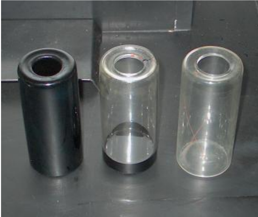
Εικόνα 1.7 Δείγματα RTFO (αριστερά: μετά τη γήρανση σε RTFO, κέντρο: πριν τη γήρανση σε RTFO, δεξιά: κενό βάζο δειγμάτων)
