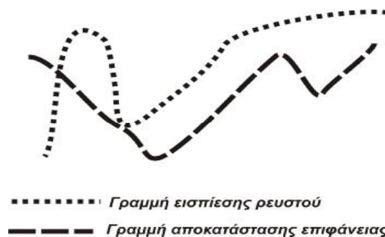
Σχήμα 3.2 Συσχέτιση γραμμής εισπίεσης νερού και αποκατάστασης επιφάνειας εδάφους.
