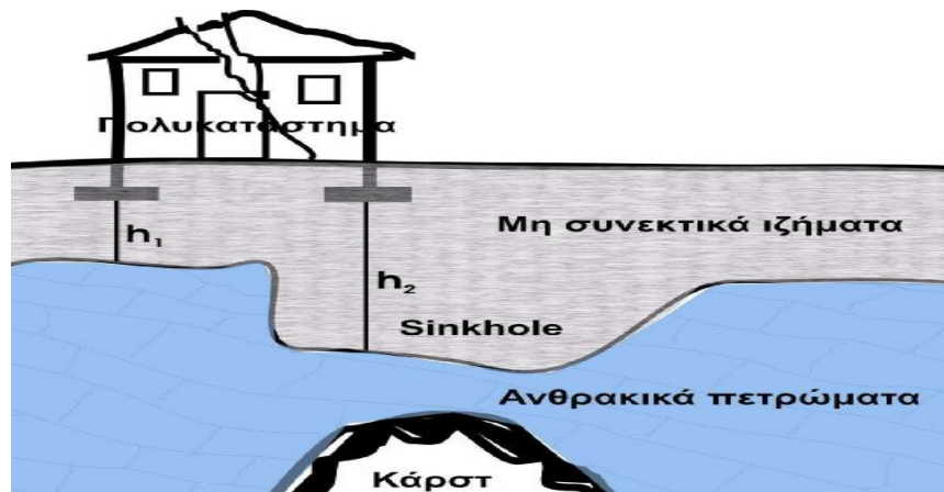
Σχήμα 3.4 Κακή επιλογή χώρου θεμελίωσης σε θέση με γρήγορη μεταβολή του μεγέθους της εδαφικής υποχώρησης.
