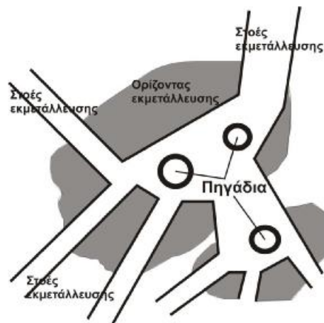
Σχήμα 4.22 Αρχική μορφή διάταξης θαλάμων και στύλων.
