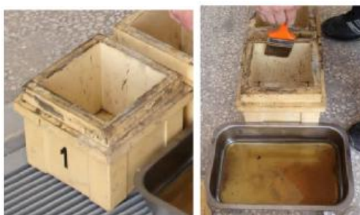
Φωτογραφίες 8.27 & 8.28 Μήτρα δοκιμίου & λάδωμα της μήτρας με ορυκτέλαιο.
