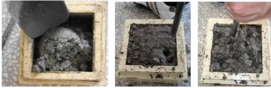
Φωτογραφίες 8.32 & 8.33 Γέμισμά της μήτρας με σέσουλα & συμπύκνωση 2 ης παρτίδας με τη σχετική ράβδο.
