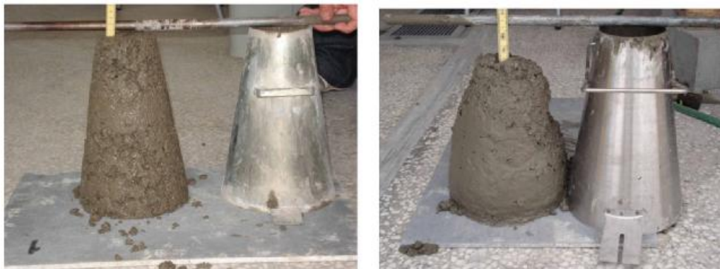
Φωτογραφία 8.22 & 8.23 Κάθιση 10 ης και 11 ης παρτίδας πριν & μετά την χρήση υπερρευστοποιητή.
