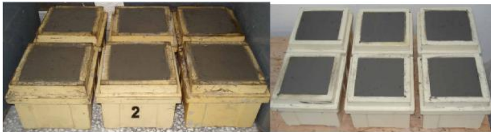
Φωτογραφία 8.37 Διατήρηση δοκιμίων μέσα στις μήτρες για τουλάχιστον 20 ώρες.
