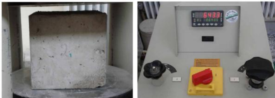
Φωτογραφίες 8.43 & 8.44 Τοποθέτηση δοκιμίου στη μηχανή θλίψης & αναπτυσσόμενη τιμή θραύσης.
