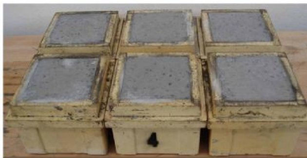
Φωτογραφία 8.38 Άνω επιφάνεια των δοκιμίων μετά από 20 ώρες.
