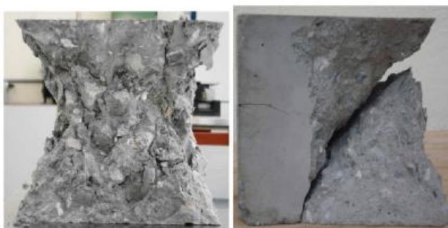
Φωτογραφίες 8.47 & 8.48 Θραύση με κώνους διατμήσεως & με επίπεδο διατμήσεως.
