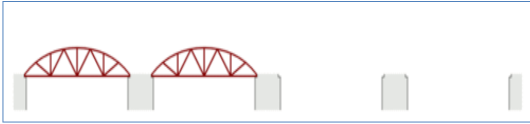
Εικόνα 24. Υποθετική αναπαράσταση της διαδικασίας κατασκευής της γέφυρας, με την κατασκευή των αψίδων σε δύο φάσεις, που επέτρεψε την αφαίρεση και επαναχρησιμοποίηση των ίδιων ξυλοτύπων.
