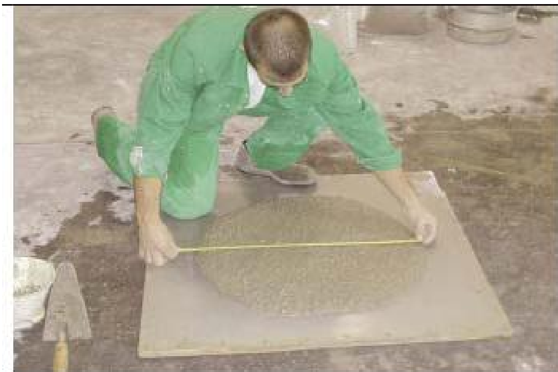
Εικόνα 8. Συσκευή μέτρησης του μέτρου εξαπλώσεως αυτοσυμπυκνούμενου σκυροδέματος.
