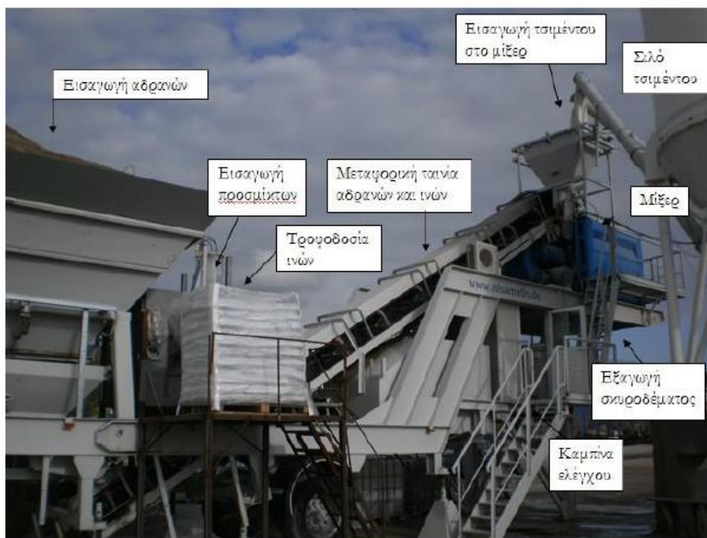
Εικόνα 28. Εξοπλισμός – Γραμμή παραγωγής σκυροδέματος.
