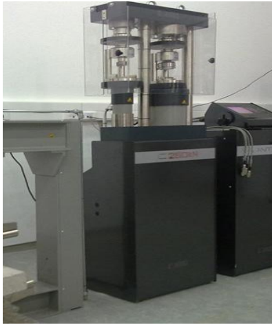
Σχήμα 3.30 Πλαίσιο θλίψης με δύο έμβολα δυναμικότητας 15 και 250 kN αντίστοιχα
