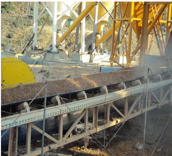
Σχήμα 2.3 Παραγωγή και μεταφορά Σκληρού Επιχώματος στο Φράγμα Φιλιατρινού Ποταμού
