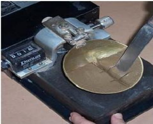
Σχήμα 3.23 Η περιοχή ένωσης των χειλιών Εγκοπής
