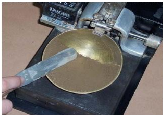
Σχήμα 3.21 Διάστρωση μίγματος στη συσκευή
