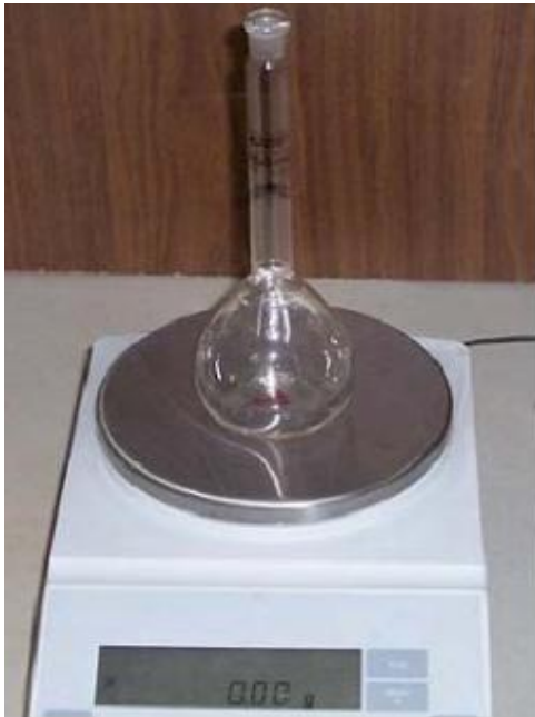
Σχήμα 3.1 Αναγωγή του μηδενός στο απόβαρο της ληκύθου.
