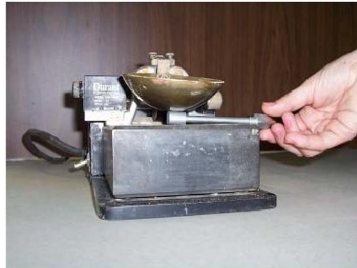
Σχήμα 3.20 Ρύθμιση συσκευής casagrande
