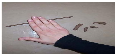
Σχήμα 3.25 Πλάσιμο του κυλίνδρου προσδιορισμού του ορίου πλαστικότητας
