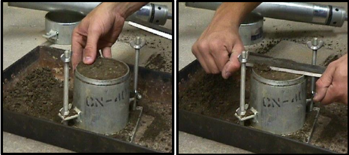
Σχήμα 3.29 Τοποθέτηση εδαφικού δείγματος σε μεταλλικό δακτύλιο και εξομάλυνση της επιφάνειάς του.
