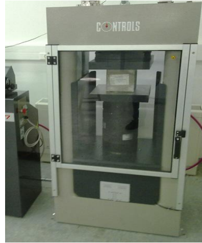
Σχήμα 3.31 Δοκιμή θλίψης σε κυβικό δοκίμιο σκυροδέματος
