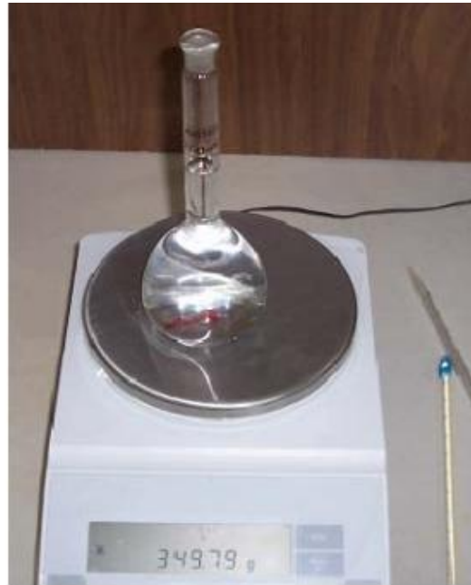
Σχήμα 3.2 Ζύγιση του περιεχομένου ύδατος της ληκύθου. Δεξιά θερμόμετρο και πιπέτα.
