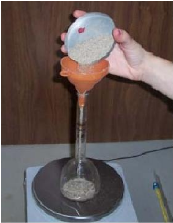
Σχήμα 3.5 Ρήψη των κόκκων ψαθυρού εδάφους στη λήκυθο.
