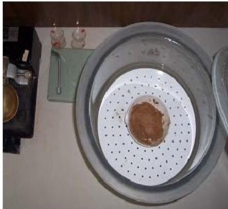
Σχήμα 3.19 Τοποθέτηση μίγματος στο θάλαμο υγρασίας
