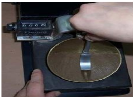
Σχήμα 3.22 Χάραξη της εγκοπής
