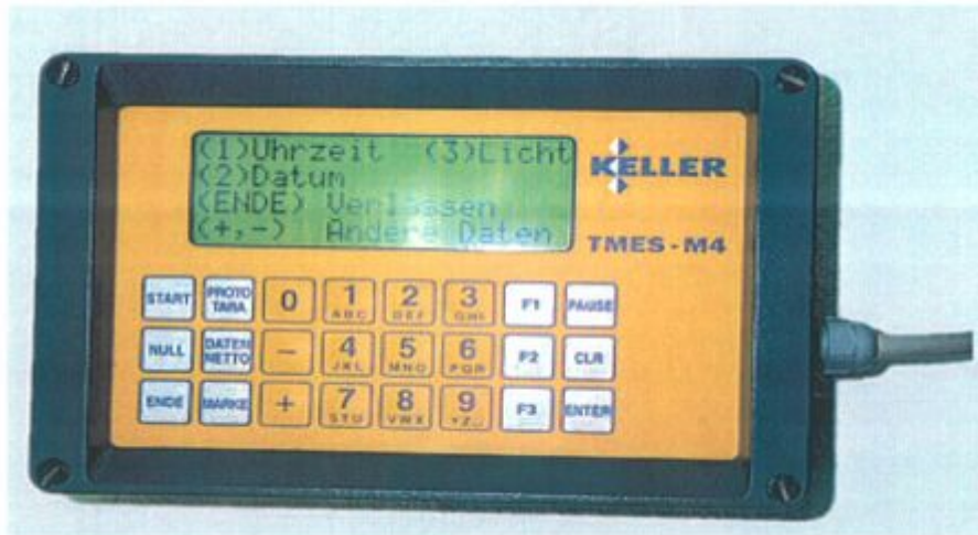
Φωτογραφία 2.1 Μια αυτόματη μηχανή καταγραφής τύπου KELLER M- Series computer για την παρακολούθηση χαλικοπασσάλων
