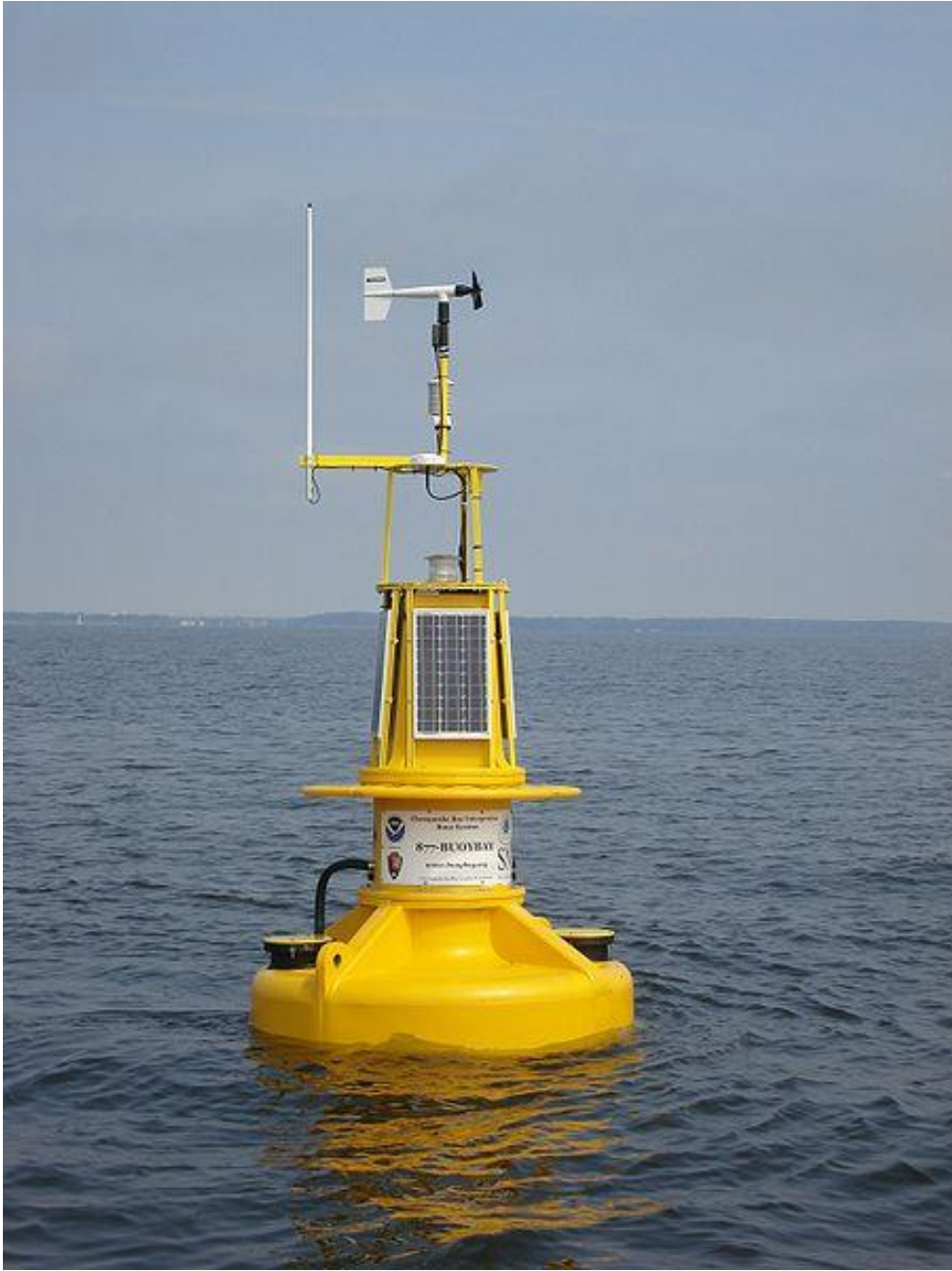
Εικόνα 2. Πλωτός σημαντήρας με ωκεανογραφικούς αισθητήρες
