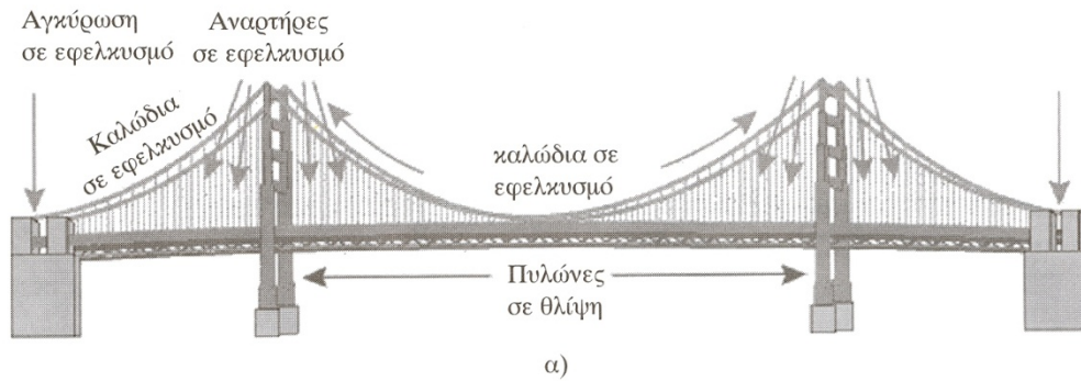
Σχήμα 2.9: Σύστημα ανάληψης δυνάμεων στις κρεμαστές γέφυρες [5] .
