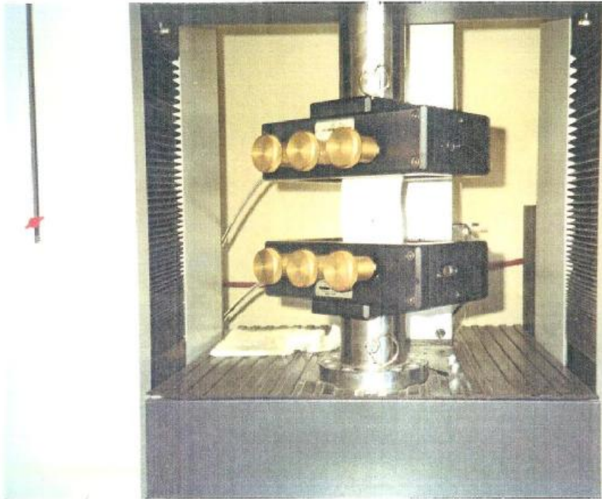
Δοκίμιο τοποθετημένο στους σφιγκτήρες πριν από την έναρξη της δοκιμής
