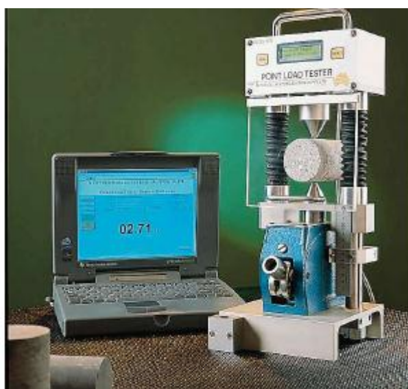
Σχήμα 4.1: Τυπική διάταξη δοκιμής σημειακής φόρτισης
