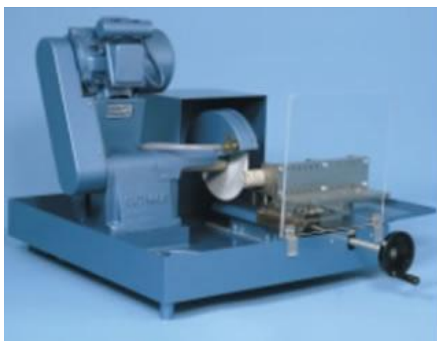
Σχήμα 2.1: Συσκευή λείανσης εδρών δοκιμίων βράχου
