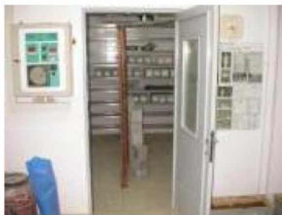
Σχήμα 2.9: α) Τυπική διάταξη υδατόλουτρου, β) Θάλαμος συντήρησης δοκιμίων σε σταθερές συνθήκες
