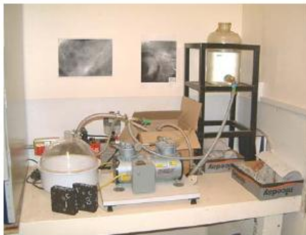
Σχήμα 2.7: Συσκευή κορεσμού δειγμάτων με κενό
