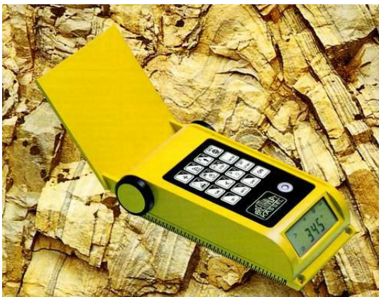
Σχήμα 1.1: Γεωλογικές πυξίδες και συλλέκτης γεωλογικών δεδομένων
