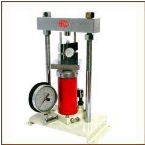
Σχήμα 3.13: Πειραματική διάταξη δοκιμής αντιδιαμετρικής θλίψης
