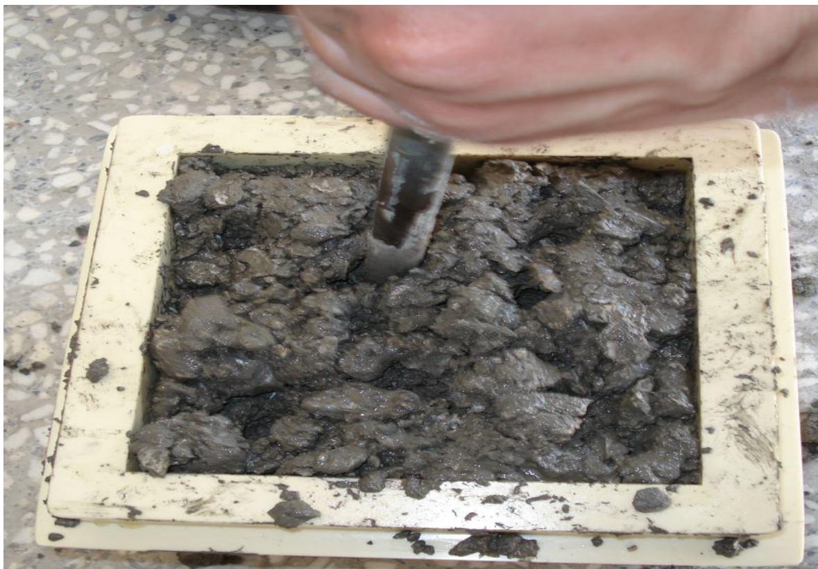
Φωτογραφίες : Γέμισμα της μήτρας με σέσουλα & συμύκνωση 2 ης στρώσης με τη σχετική ράβδο.
