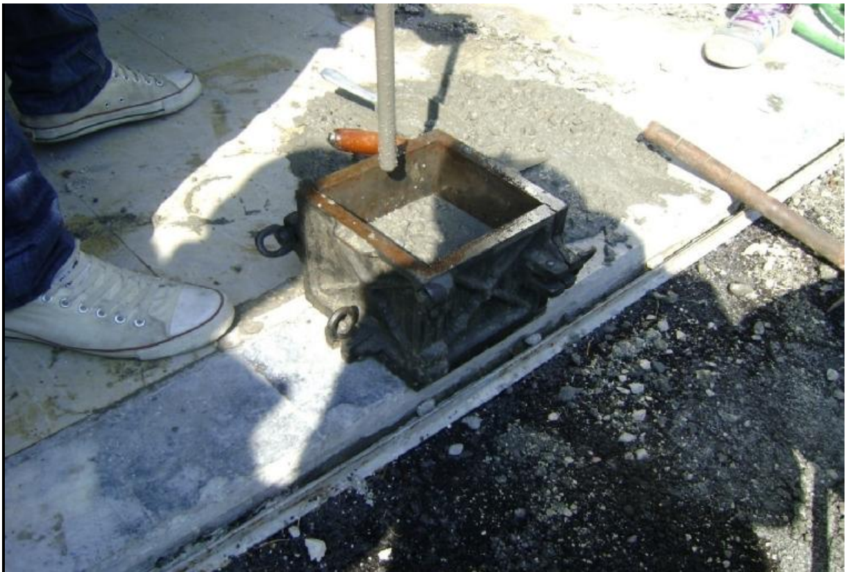
Φωτογραφίες : Συσκευή δονητή & συμπύκνωση με δονητή.
