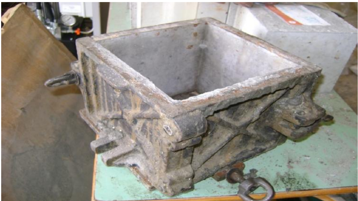
Φωτογραφίες: Μήτρες δοκιμίου 15×15×15 cm.
