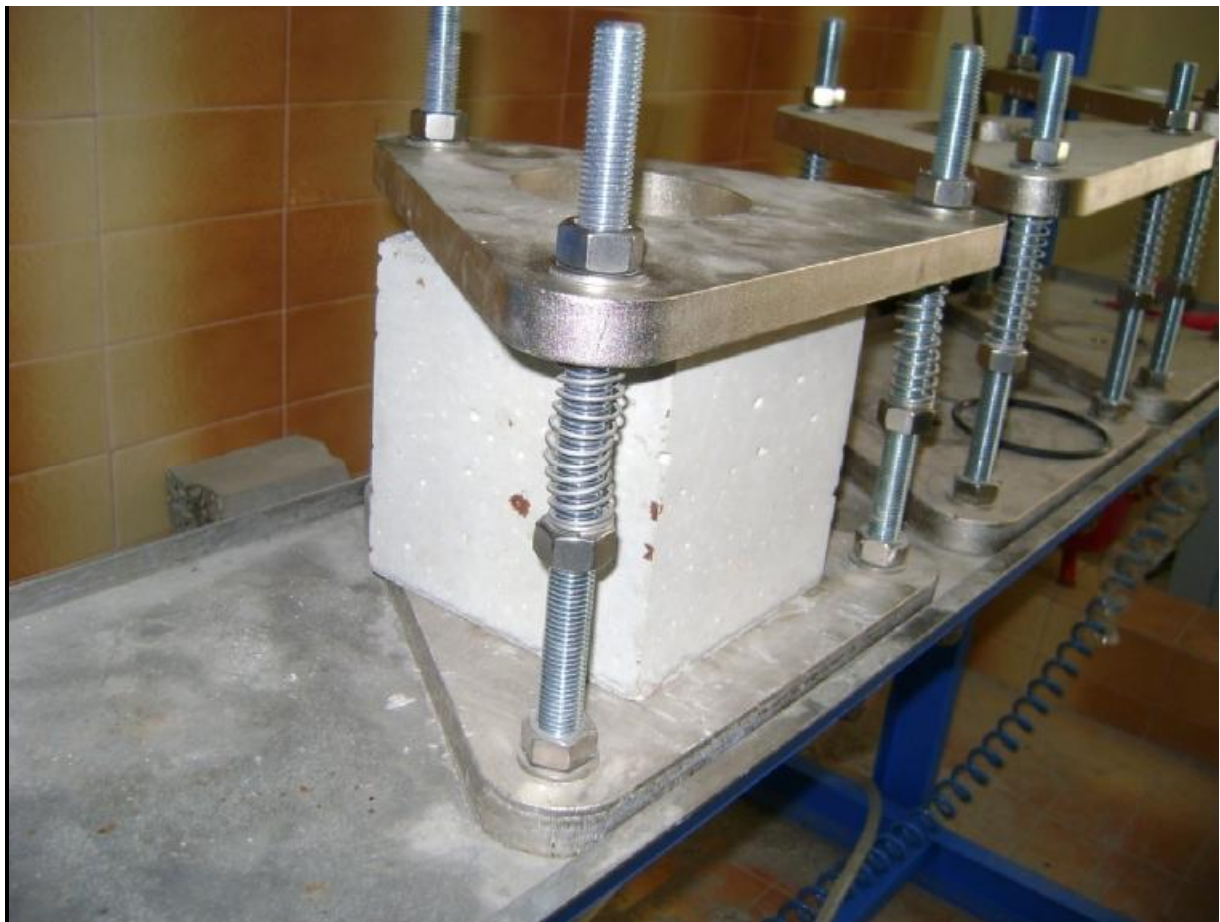
Φωτογραφία: Τοποθέτηση δοκιμίου στη συσκευή υδατοπερατότητας.
