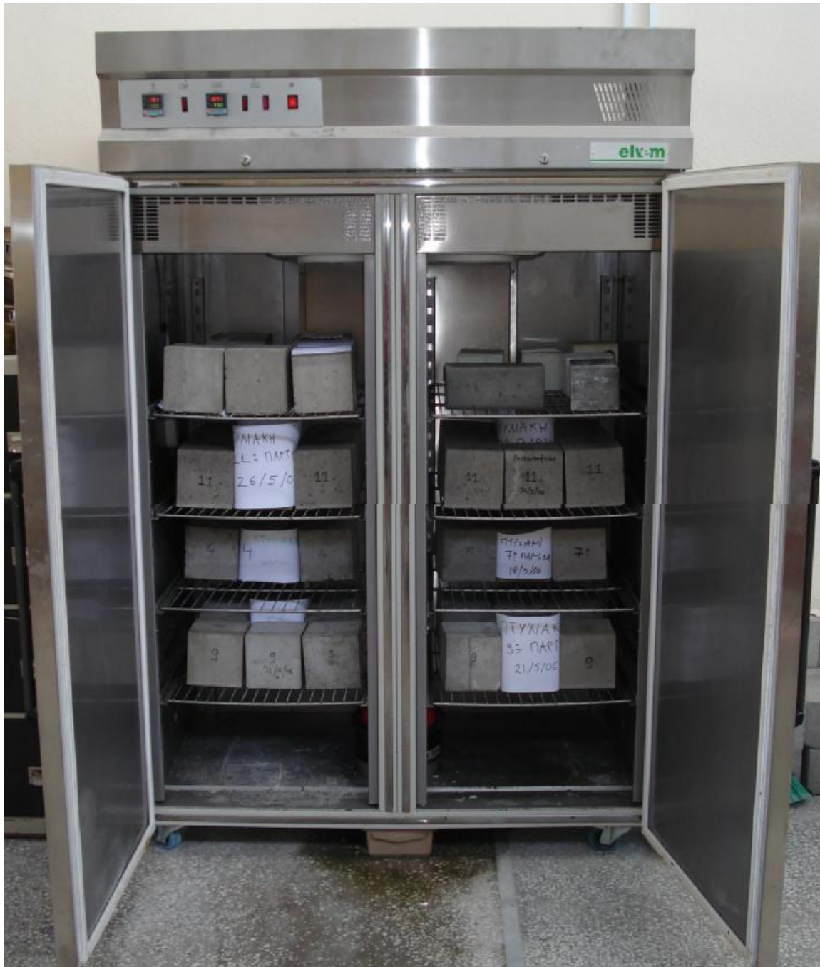
Φωτογραφία: Δοκίμια μέσα στον θάλαμο συντήρησης.
