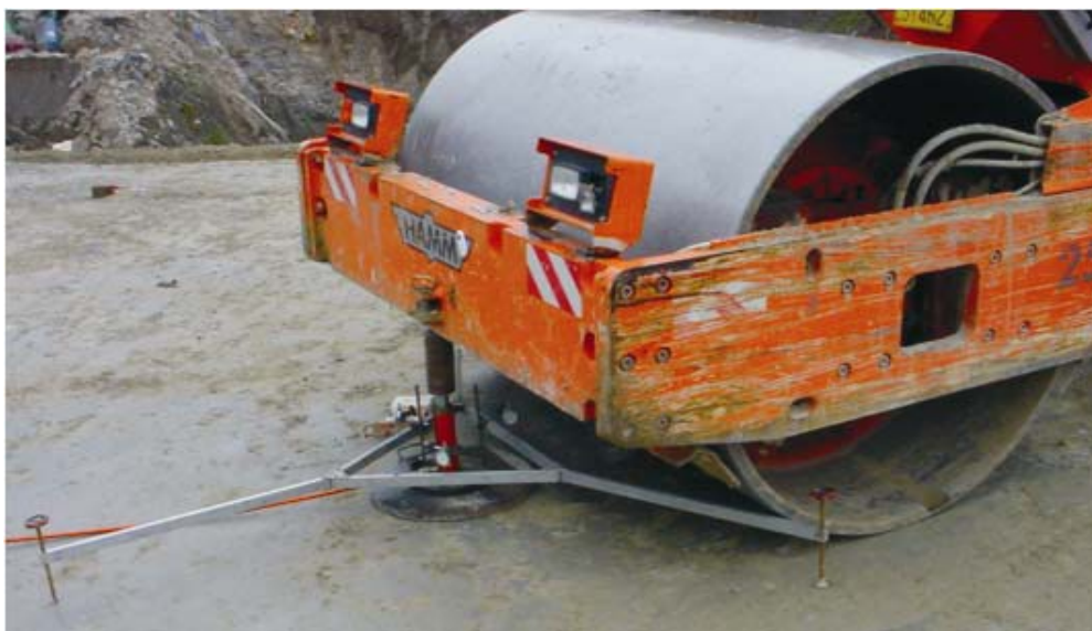
Εικόνα 2.4 Δοκιμή φόρτισης πλάκας
