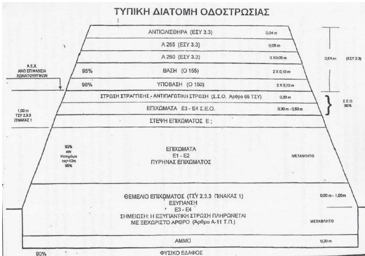
Εικόνα 3.24 Τυπική διατομή οδοστρώσας
