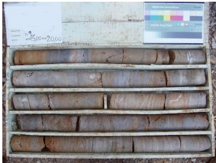
Εικόνα 2.1 Πυρηνοληγία με βραχώδες δείγμα
