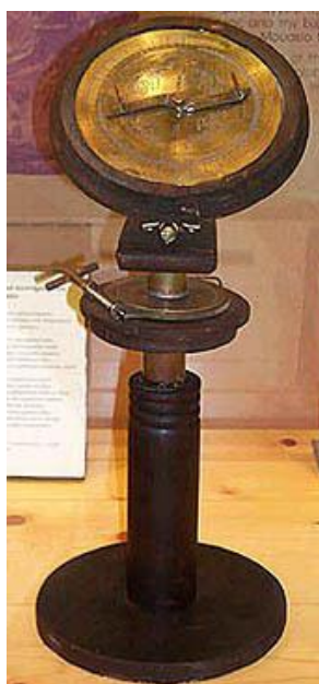
Εικόνα 31. Διόπτρα του Ήρωνα (Πηγή: [24]).
