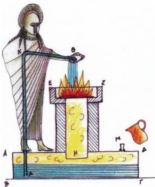
Εικόνα 20. Απεικόνιση Λειτουργίας της Αυτόματης Σπονδής (Πηγή: [13]).
