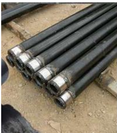
Εικόνα 22. Μεταλλικοί δοκοί προπορείας
