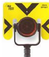
Εικόνα 36. Στόχος πρίσματος (prism target)
