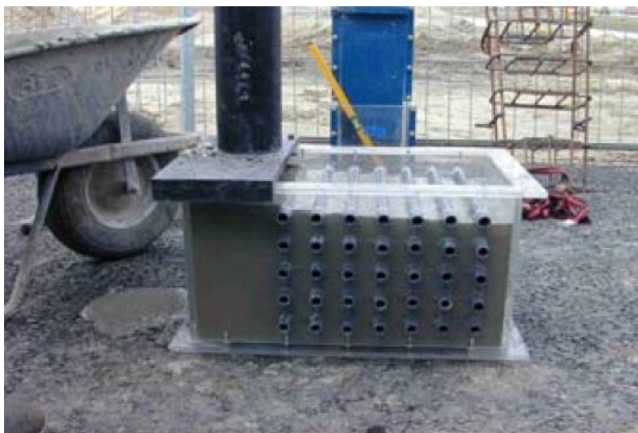
ΣΧΗΜΑ 11.2. Fill Box Test
