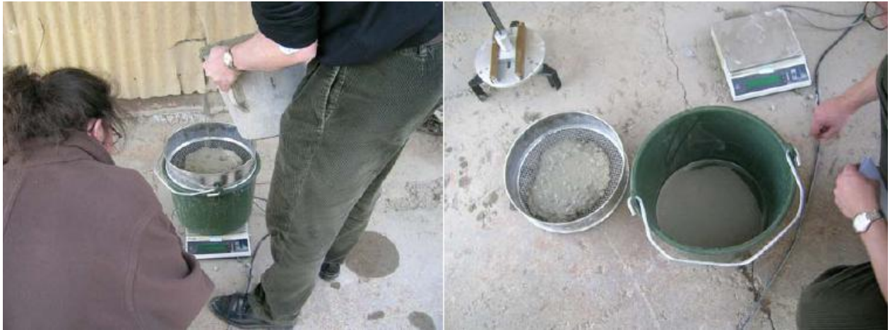
ΣΧΗΜΑ 10. Δοκιμή αντίστασης στην απόμιξη με κόσκινο (Sieve segregation resistance Test)
