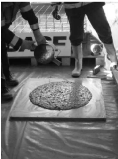
Εικόνα 7.1: με χρήση RheoMATRIX® «...Η διαφορά στην εξάπλωση των δύο σκυροδεμάτων (με και χωρίς RheoMATRIX®) είναι εμφανής...»
