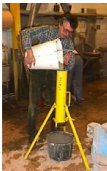
ΣΧΗΜΑ 12. Δοκιμή Orimet
