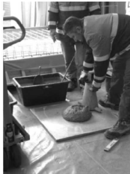
Εικόνα 7.2: χωρίς «...Η διαφορά στην εξάπλωση των δύο σκυροδεμάτων (με και χωρίς RheoMATRIX®) είναι εμφανής...»
