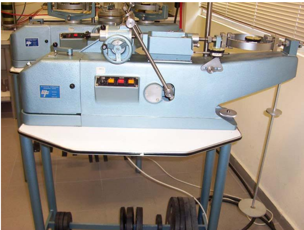
Δοκιμή άμεσης διάτμησης του εργαστηρίου του Τ.Ε.Ι Πάτρας
