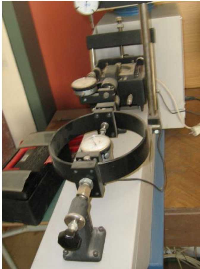
Δοκιμή άμεσης διάτμησης του εργαστηρίου του Τ.Ε.Ι Πάτρας
