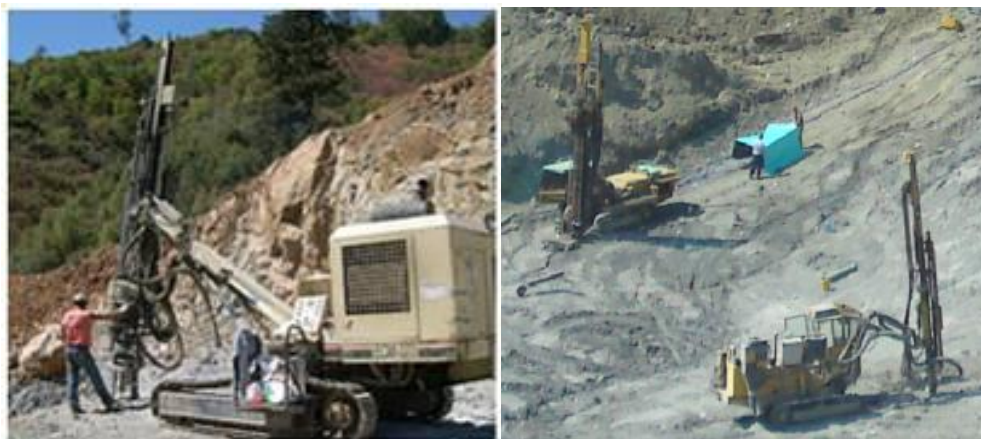
Σχήμα 4.1 Φορητά γεωτρήματα περιστροφικού τύπου
