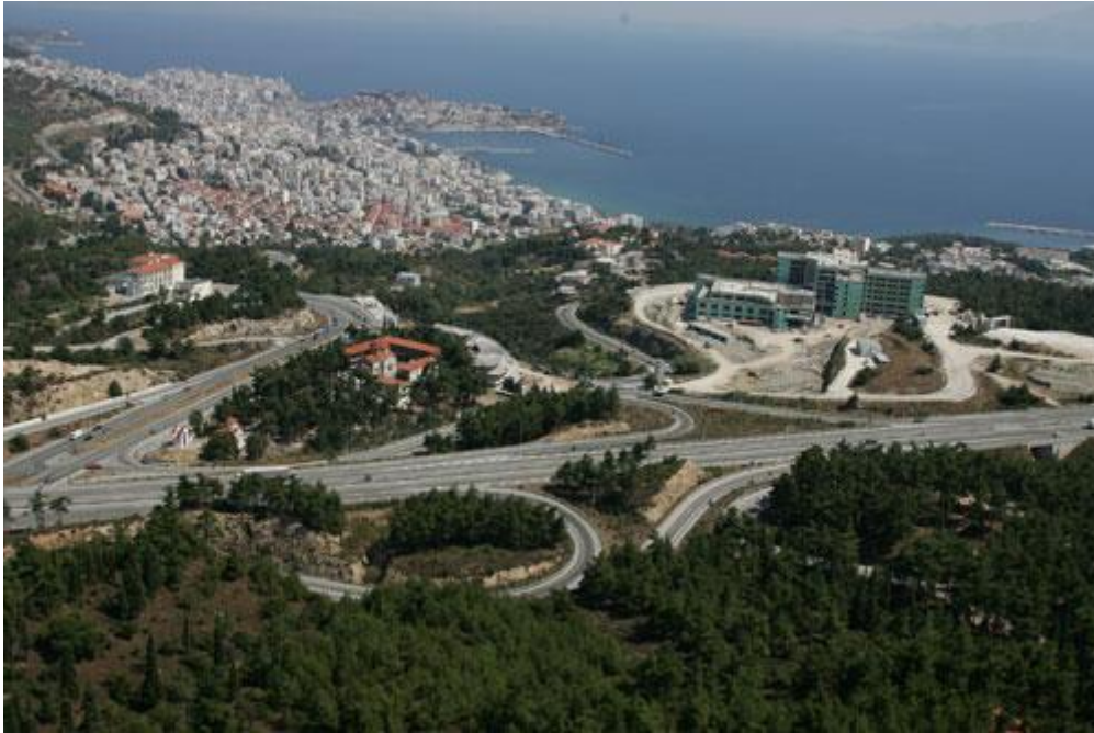
Εικ. 3.3 Ανισόπεδος κόμβος μορφής «μέρος Τριφυλλιού», Εγνατία Οδός, (Α/Κ Αγ. Σύλλα, Καβάλα)
