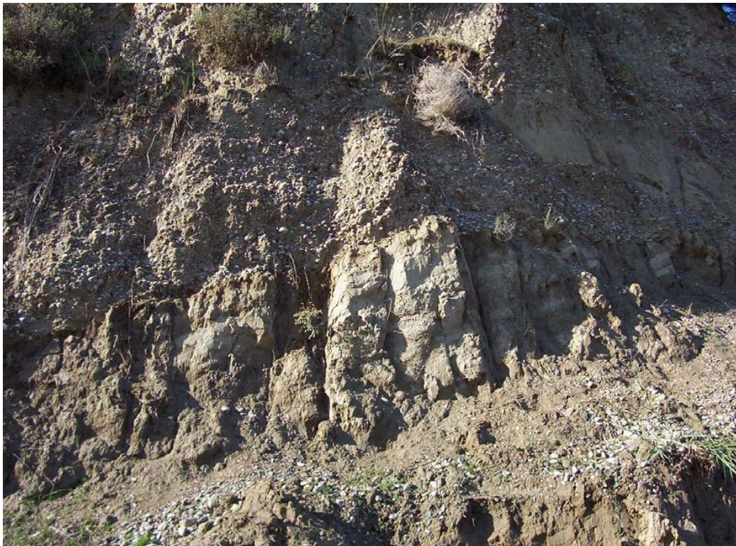
Σχήμα 3.20 Ενστρώσεις κροκαλοπαγών πάχους έως 1 m μέσα στον Ανώτερο μαργαϊκό ορίζοντα. Χ.Θ. 0+800.
