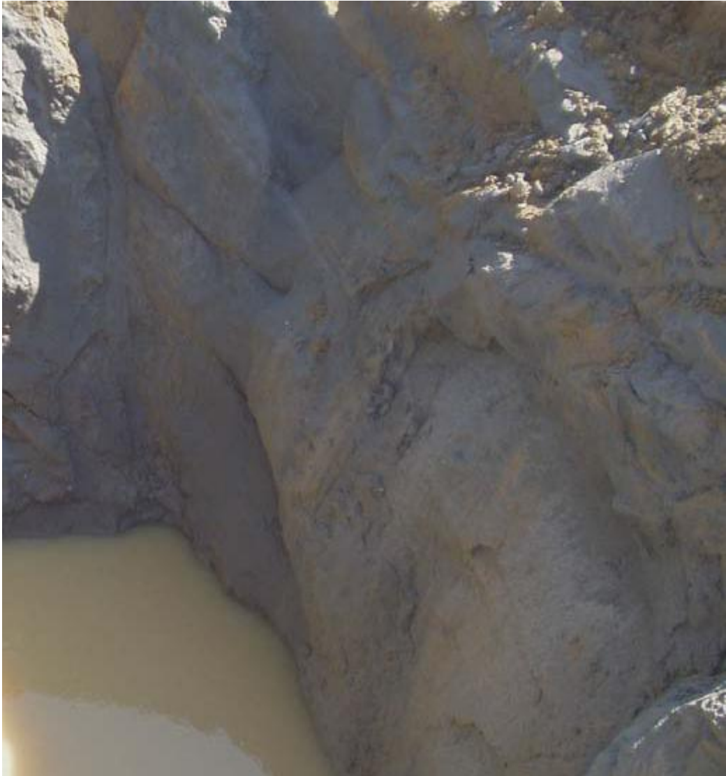
Σχήμα 3.18 Διακρίνεται ο κατώτερος μαργαϊκός ορίζοντας με κυανόγκριζο χρώμα και ιλυώδη αργιλική σύσταση.
