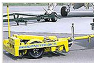
Σχήμα 5.11. : Μηχάνημα skiddometer , διεξαγωγής μετρήσεων ( www.thetestequipment.com ).
