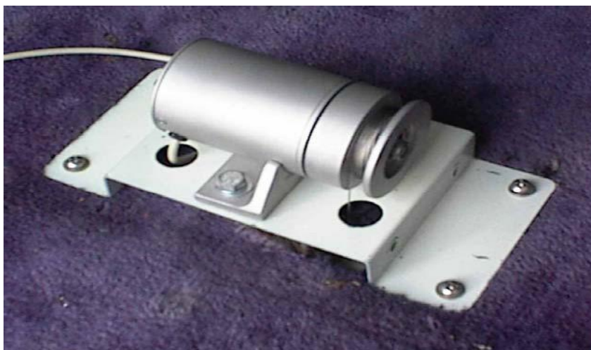
Σχήμα 3.3. : B.I. (Bump integrator , μετρητής προσκρούσεων) ( www.romdas.com )
