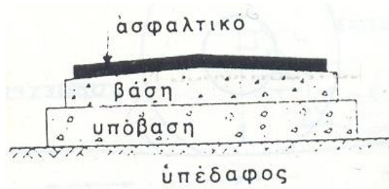
Σχήμα 1.2. : Εγκάρσια τομή εύκαμπτου οδοστρώματος.(Ι. Κοφίτσας – 2001).
