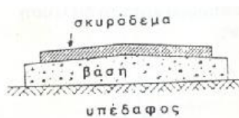
Σχήμα 1.5. : Εγκάρσια τομή δύσκαμπτου οδοστρώματος. Ι. Κοφίτσας 2001
