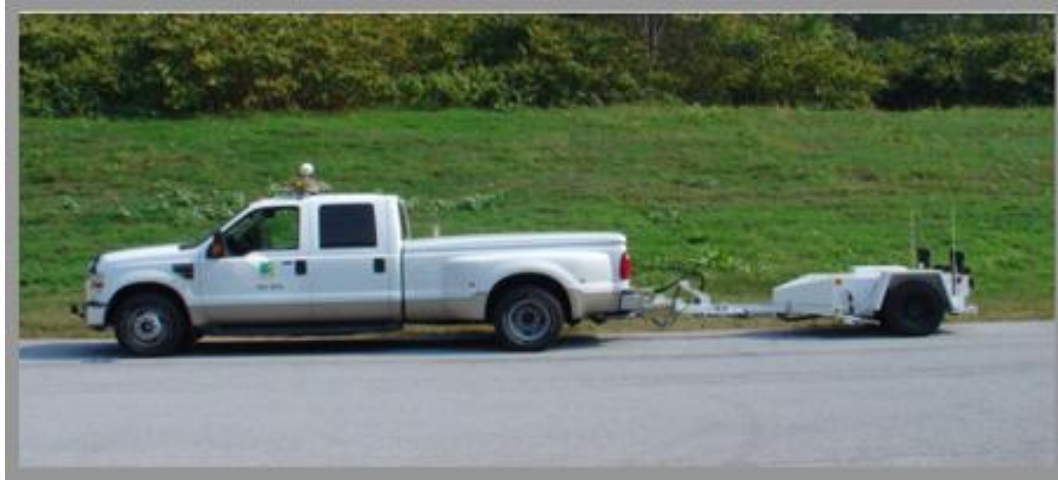
Σχήμα 5.10. : Αυτοκίνητο πραγματοποίησης των μετρήσεων μαζί με το trailer ( www.dot.state.pa.us ).
