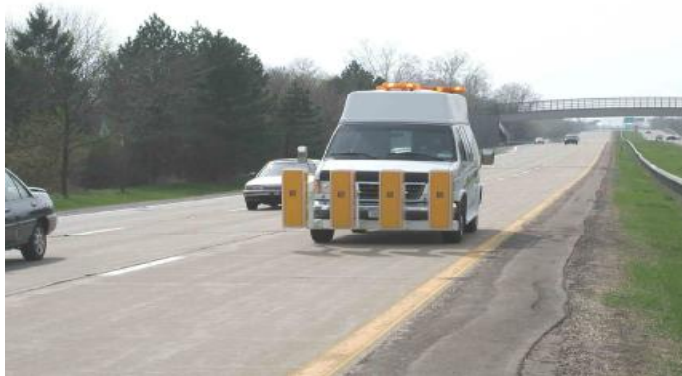
Σχήμα 3.6. : Όχημα επιθεώρησης, εξοπλισμένο με GPR ( www.utexas.edu ).
