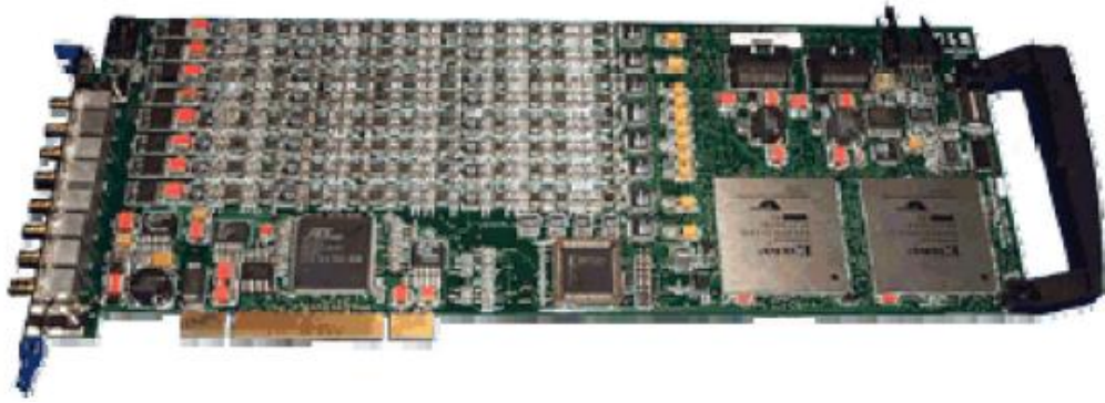
Σχήμα 16. Ψηφιακό σύστημα καταγραφής δεδομένων ΑΕ
