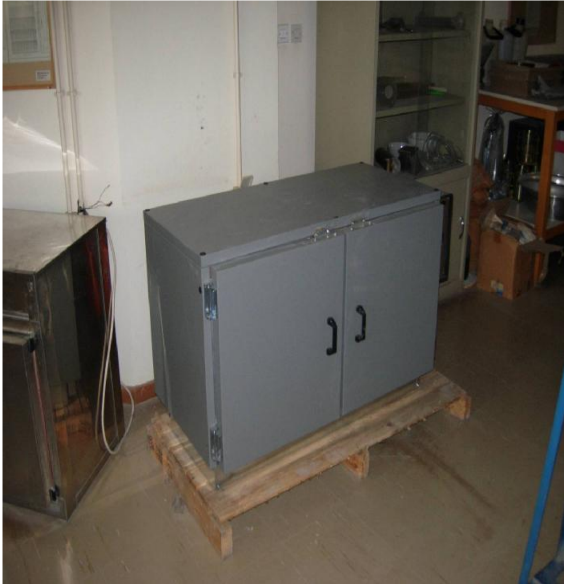
Εικόνα 4.1. Κλίβανος ξήρανσης ( εργαστηρίου εδαφομηχανικής Α Τ.Ε.Ι. Πάτρας)
