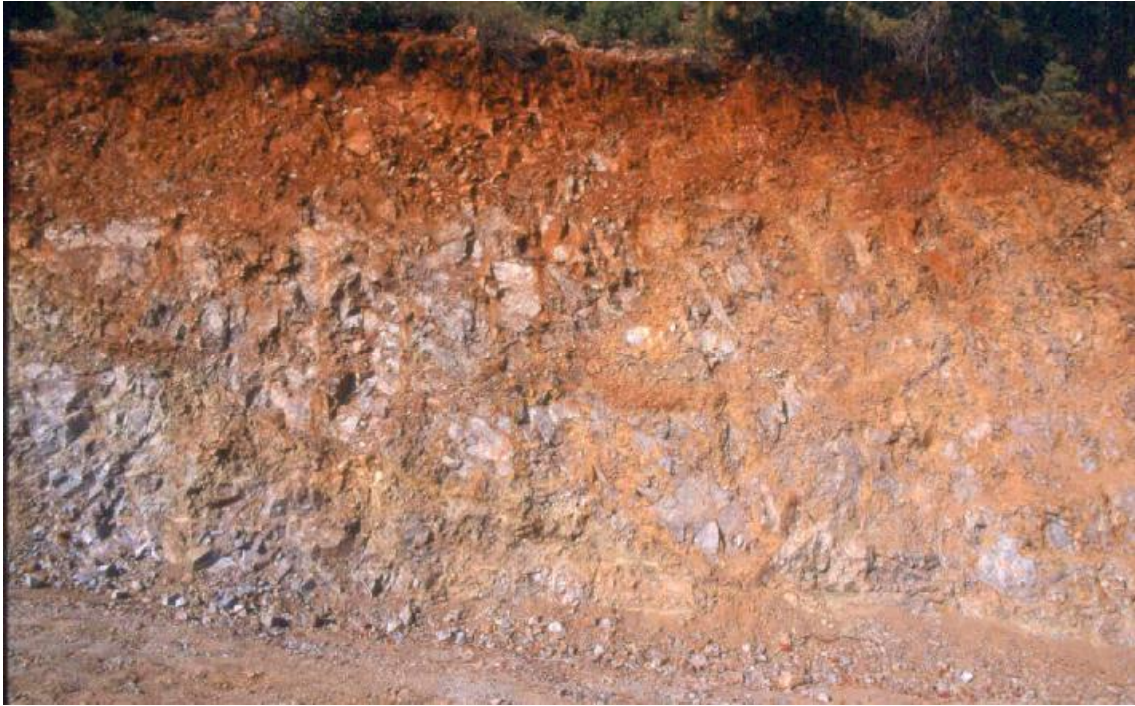
ΦΩΤ 3 Τεκτονικό διάγραμμα (ΤΔ-3) σε σερπεντινωμένους χαρτζβουργίτες (ha), στη Χ.Θ. 9+400.
