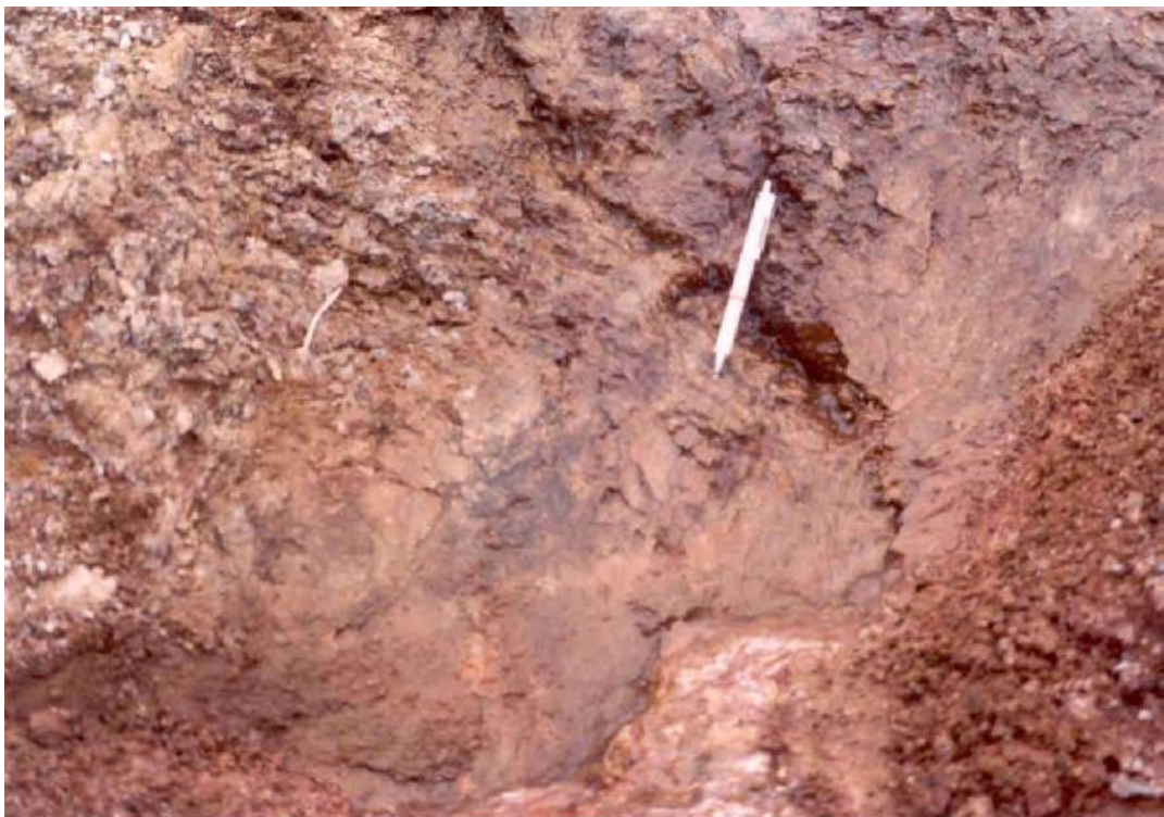
Φωτ. 8 Επιφάνεια ολίσθησης του ενεργού κρασπεδικού ρήγματος Νο3 στην περιοχή του νοτίου τμήματος (Μόδι).
