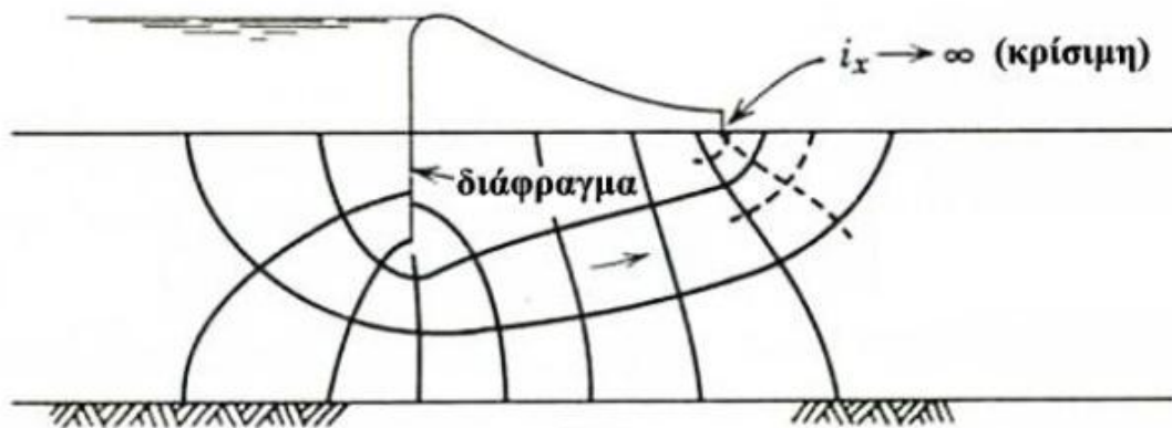
Σχήμα 2.4 Απειρισμός της υδραυλικής κλίσης εξόδου λόγω ανεξέλεγκτης ροής
