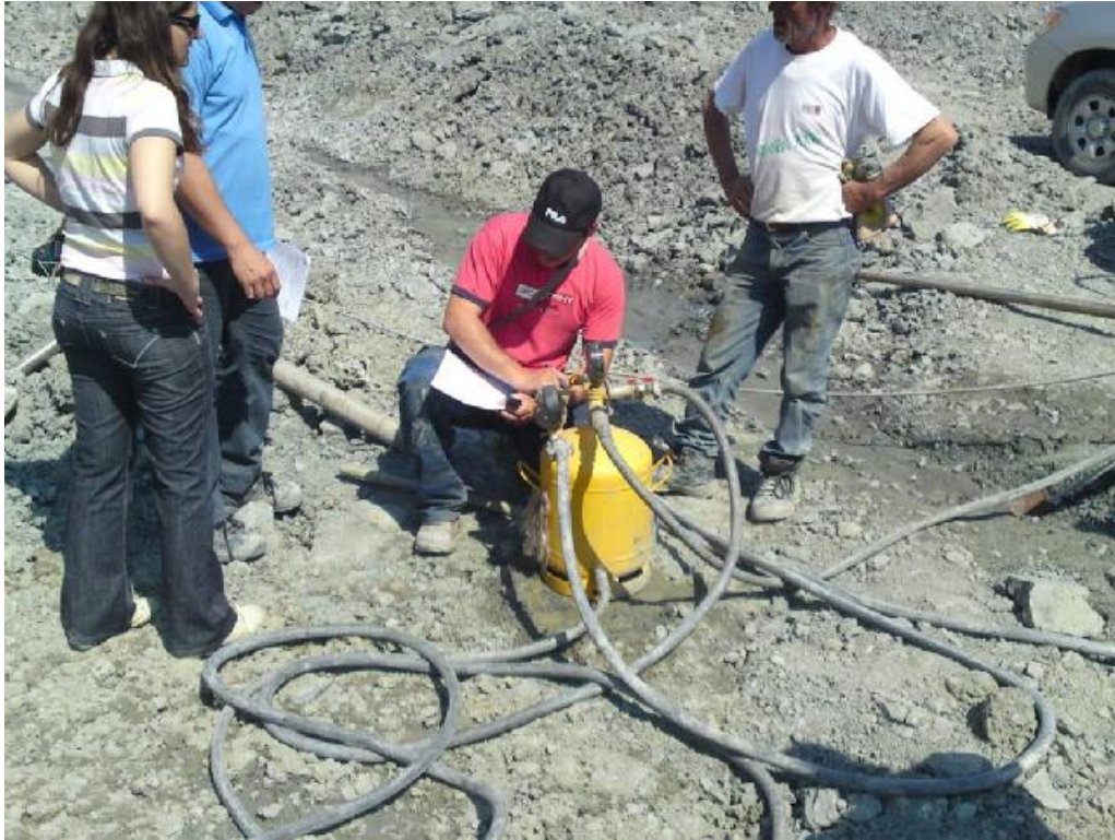
Σχήμα 5.23 Πιεστικό καζανάκι δοκιμής Lugeon (μανόμετρο, υδρομετρητής και βαλβίδα ανακούφισης) για τη μέτρηση της ποσότητας νερού που απορροφάται
