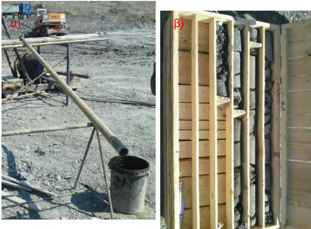
Σχήμα 5.16 α) Κοπτικό άκρο – πυρηνολήπτης (καροταρία) γεωτρήσεων και β) δείγματα προς αποθήκευση
