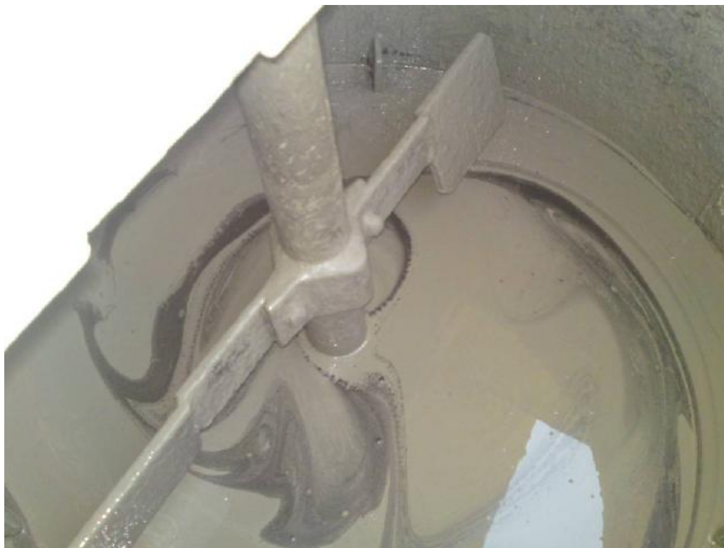
Σχήμα 5.21 Ανάδευση του ενέματος για την αποφυγή εξίδρωσης και απόμιξης
