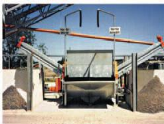
Συγκρότημα ανακύκλωσης με δύο αποστραγγιστικούς κοχλίες παραγωγής δύο προϊόντων για κονιάματα και άνοδρο ασβέστιο (κατασκ. Bibko)
