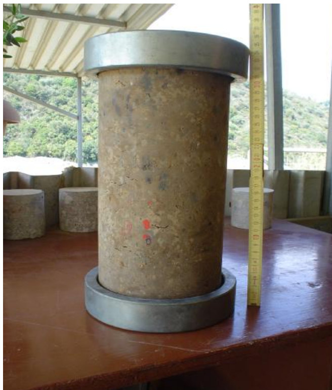
Εικόνα 4.13. Δοκίμιο Σκληρού Επιχώματος
