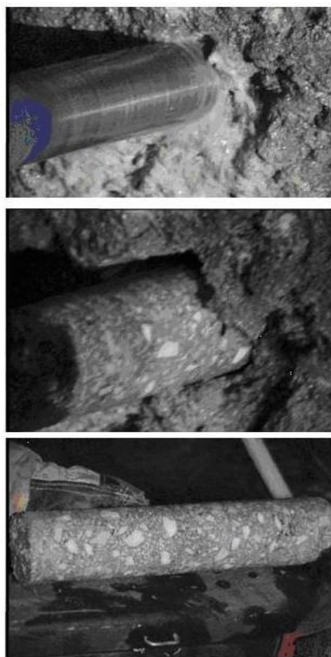
Εικόνα 2.15. Πυρηνοληψία: Λήψη καρótων από σήραγγα
