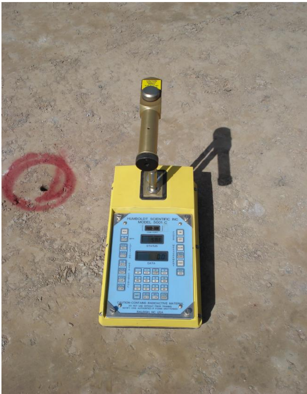
Εικόνα 4.12. Πυρηνικός μετρητής για έλεγχο συμπίκνωσης Σκληρού Επιχώματος
