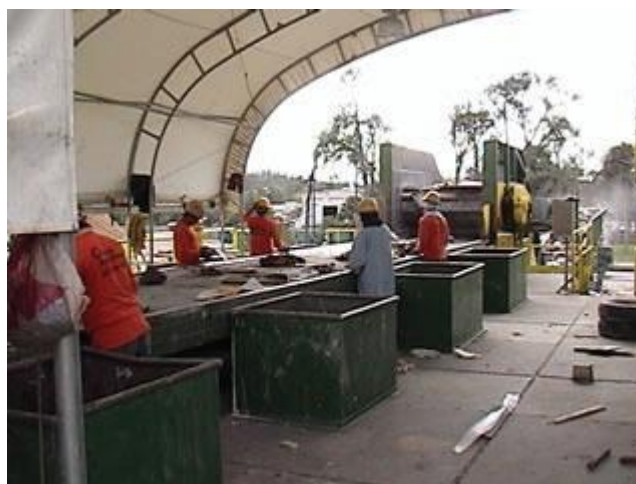
Εικόνα 5.9. Ιμάντας διαλογής. Κατασκ. OEM. Συστήματα απομάκρυνσης ακατάλληλων προσμίξεων από υλικά για ανακύκλωση
