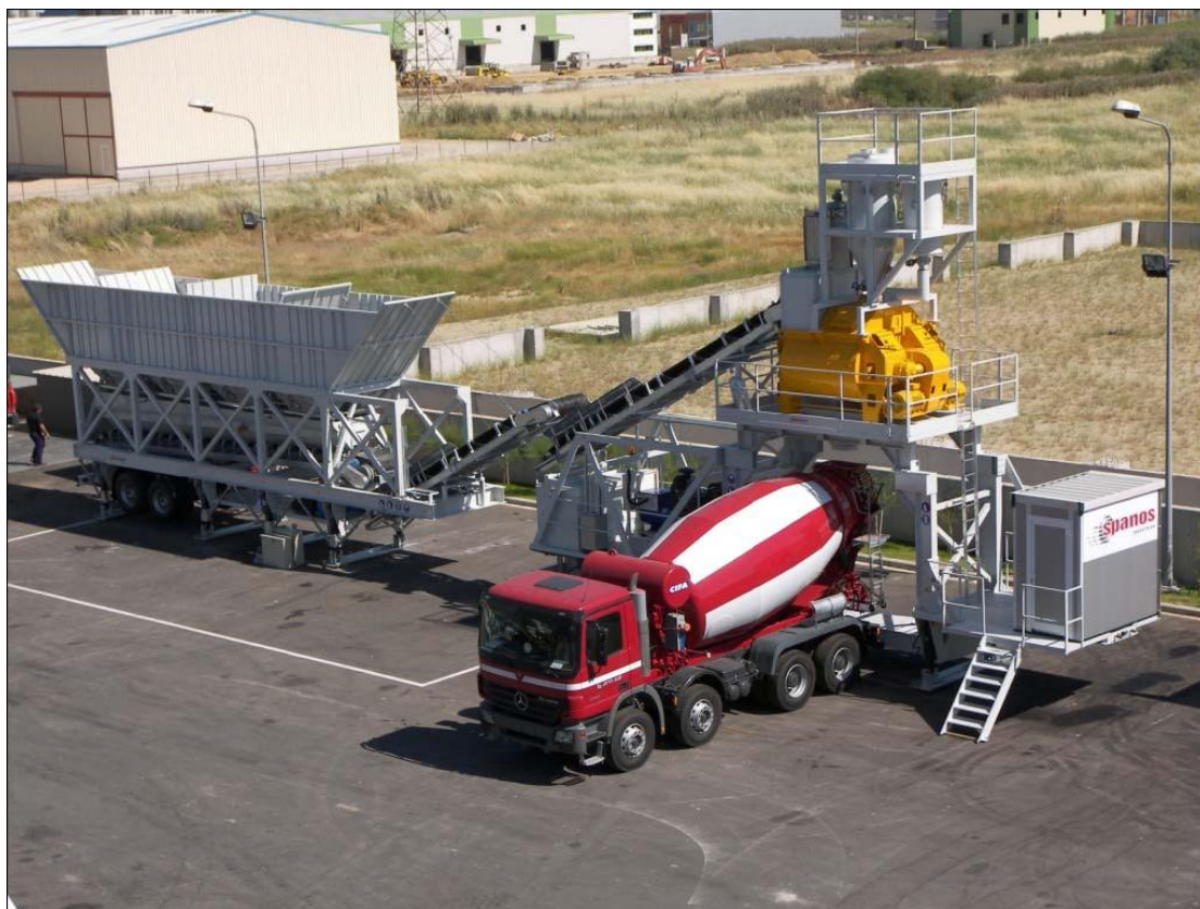
Εικόνα 5.1: Κινητό συγκρότημα παραγωγής σκυροδέματος
