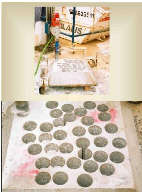
Εικόνα 2.13. Δοκίμια που αποκάμπτωνται από ειδικά φατνώματα για λήψη πυρήνων.
