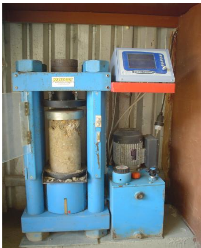
Εικόνα 4.16. Διαδικασία θραύσης δοκιμίου
