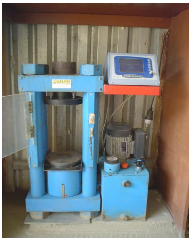
Εικόνα 4.14. Συσκευή θραύσης δοκιμίων Σκληρού Επιχώματος
