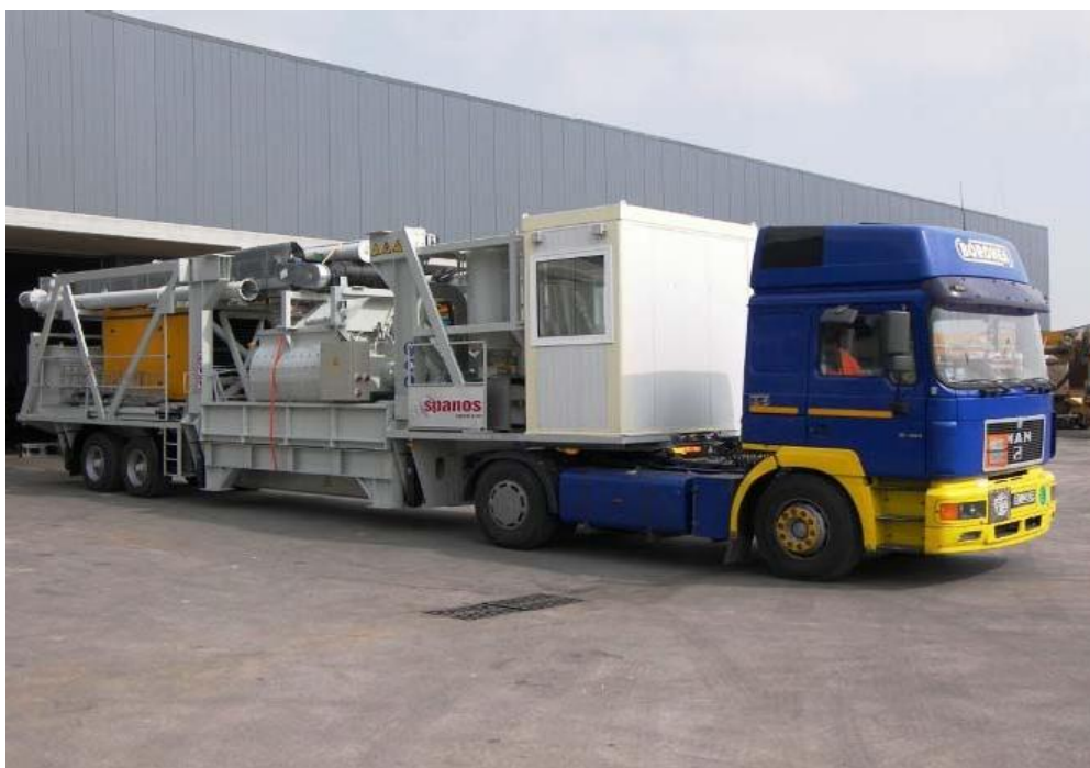
Εικόνα 5.2: Μεταφορά κινητού συγκροτήματος παραγωγής σκυροδέματος
