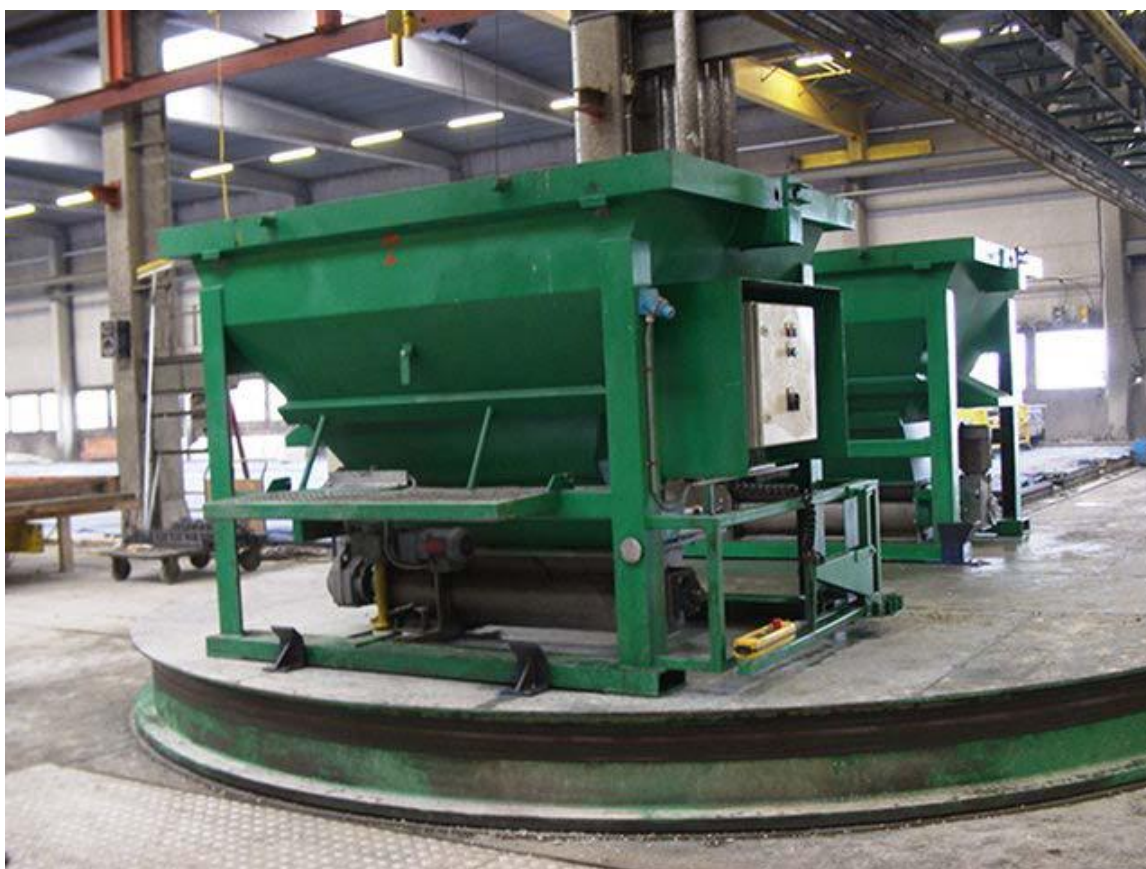
Εικόνα 3.20: Κατασκευή προκατασκευασμένου στοιχείου από αυτοσυμπκνούμενο σκυρόδεμα
