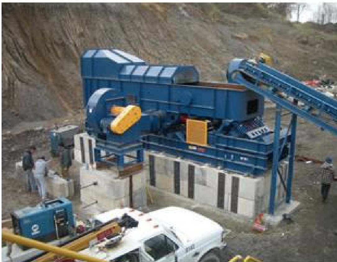
Εικόνες 5.6-5.7. De-Stoner. Διαχωριστής και διαλογέας υλικών Κατασκ. Ο.Ε.Μ.
