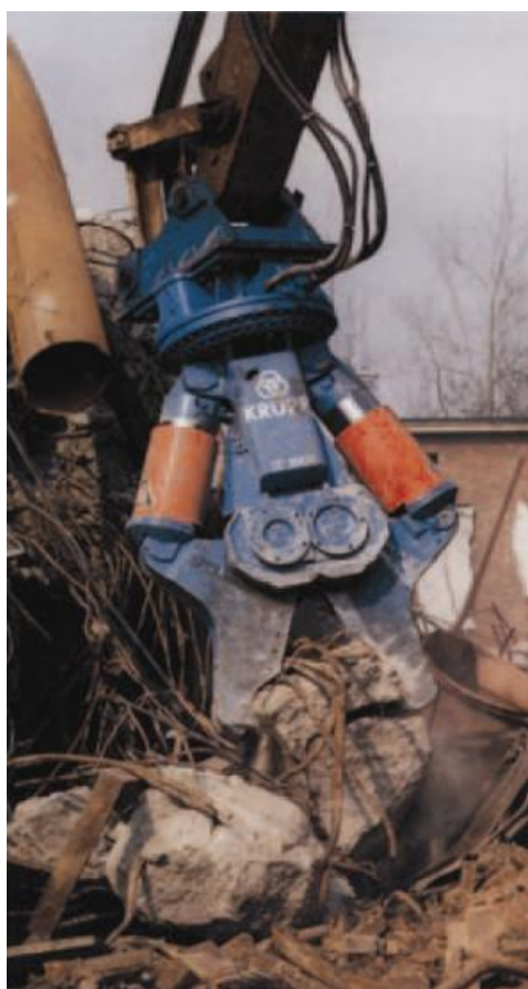
Εικόνα 5.10. Θρυμματιστής Σκυροδέματος. Krupp CC4000
