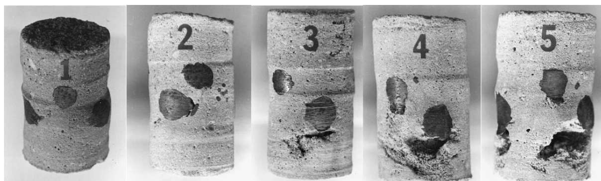
Εικόνα 2.12. Κατηγοριοποίηση ποιότητας Ε.Σ. με βάση τον οπτικό έλεγχο. Πιθανές εικόνες των πέντε κατηγοριών.
