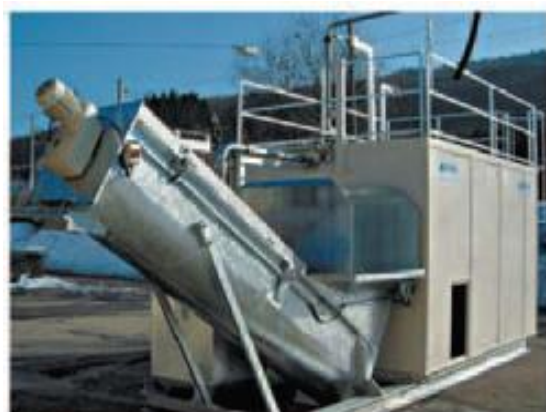
Μεταφερόμενο συγκρότημα ανακύκλωσης επί μεταλλικού ελκίθρου (κατασκ. Bibko)
