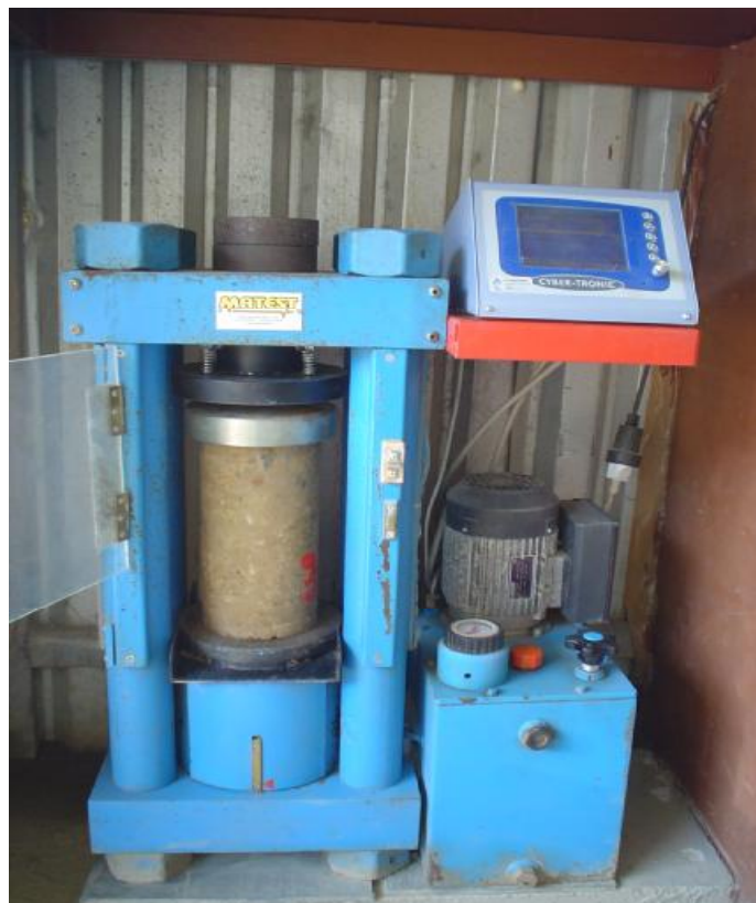
Εικόνα 4.15. Διαδικασία θραύσης δοκιμίου
