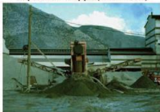
Μεταφερόμενο συγκρότημα ανακύκλωσης επί μεταλλικού ελκίθρου (κατασκ. Bibko)
