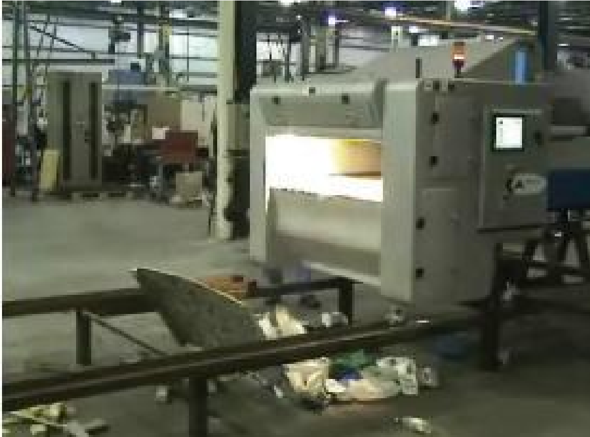
Εικόνα 5.4.Οπτικό σύστημα διαλογής Aquila. Κατασκ. Eagle Vizion
