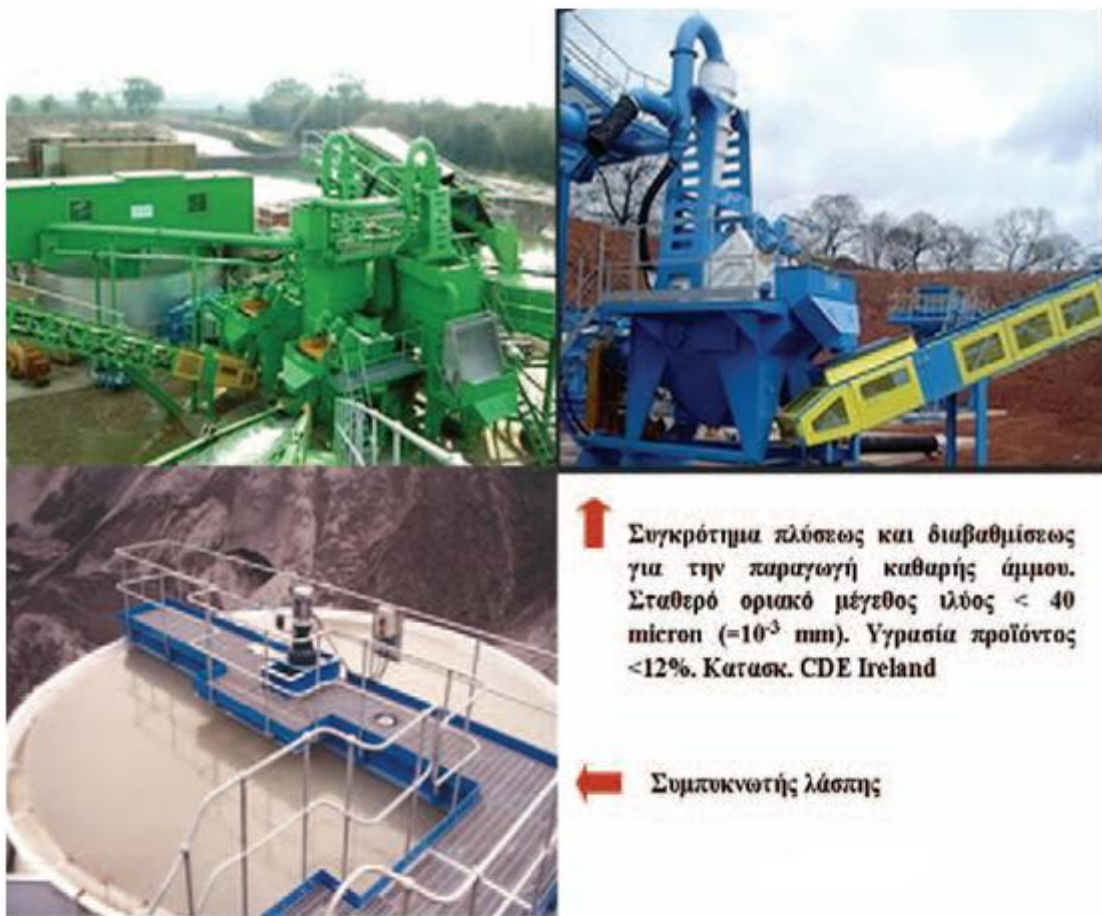
Εικόνα 5.12. Μηχανικές μονάδες του συγκροτήματος πλύσεως και διαβαθμίσεων αδρανών υλικών από ανακύκλωση παλαιών σκυροδεμάτων. (πηγή CDE Ireland)
