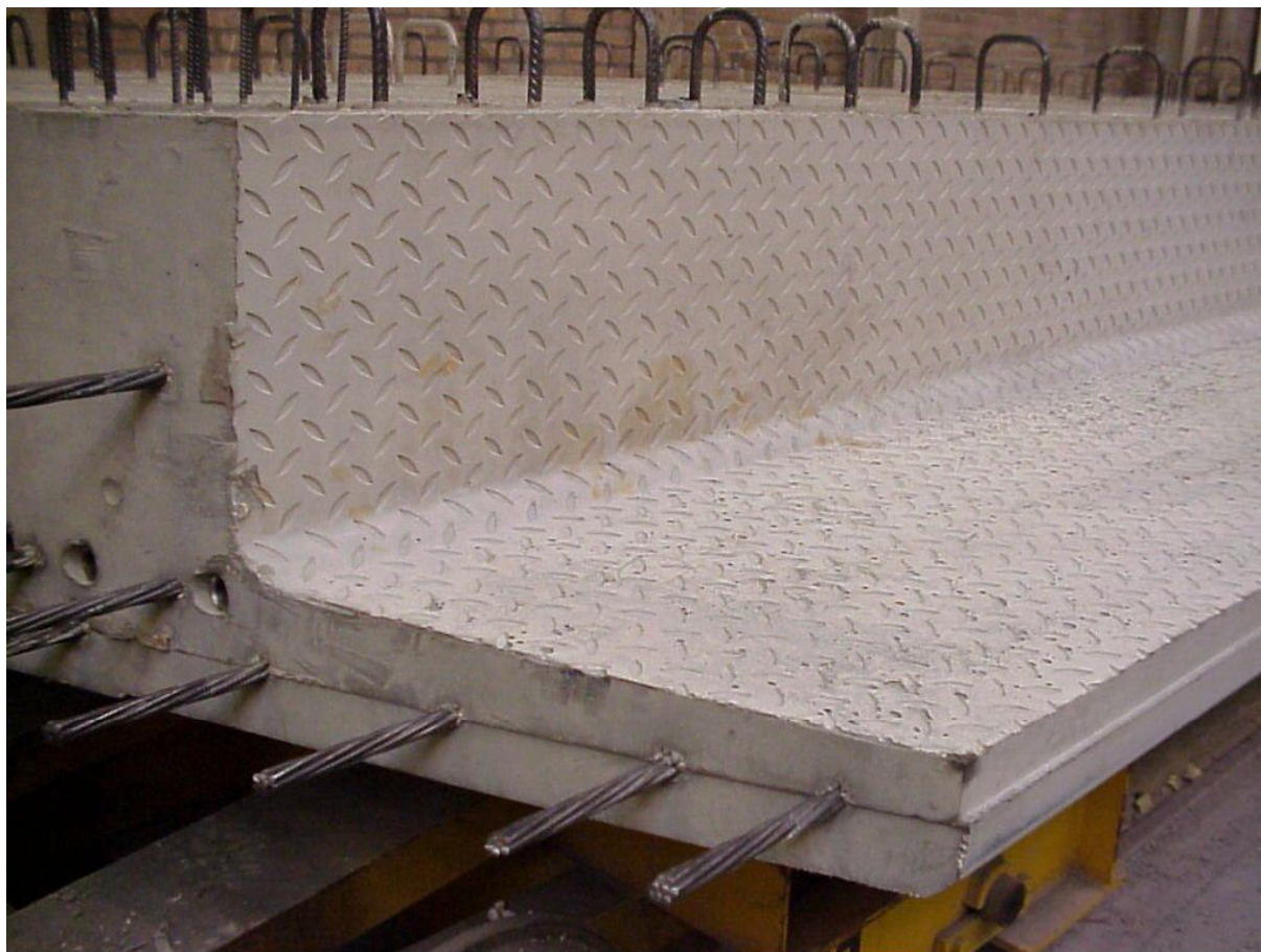
Εικόνα 3.2. Αυτοσυμπυκνούμενο σκυρόδεμα με ίνες από χάλυβα
