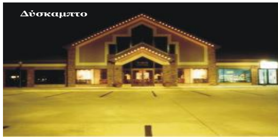
Σχήμα 10. Σύγκριση της ορατότητας τη νύχτα μεταξύ εύκαμπτου και δύσκαμπτου οδοστρώματος
