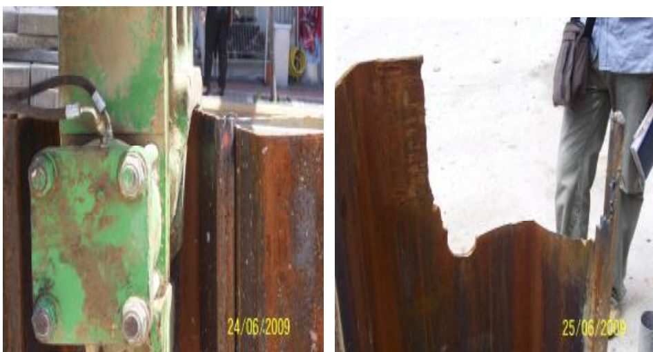
Σχ 8-4 Λιώσιμο και Σπάσιμο πασσαλοσανίδων
