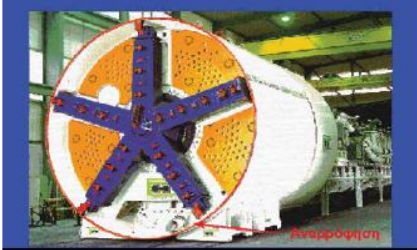
Μηχανή TBM με slurry shield
