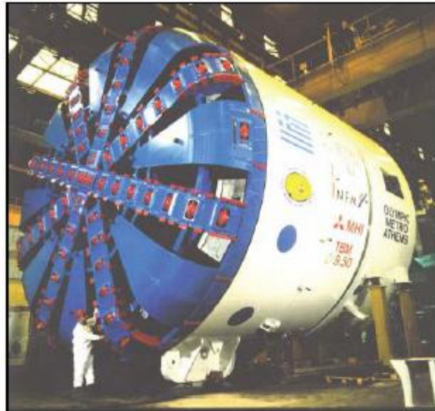
Τμήμα της μηχανής TBM που χρησιμοποιήθηκε για την διάνοιξη των σηράγγων του Μετρό της Αθήνας
