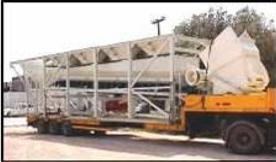
Μεταφορά Κινητού Συγκροτήματος Παραγωγής Έτοιμου Σκυροδέματος
