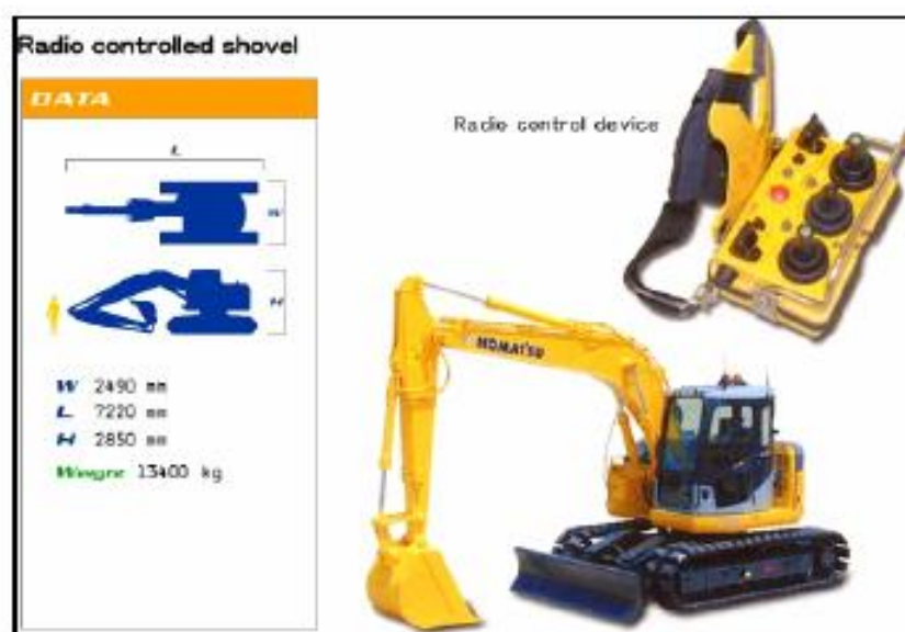
Τηλεχειριζόμενος υδραυλικός εκσκαφέας. Σε παράθεση η ασύρματη μονάδα τηλεχειρισμού.
