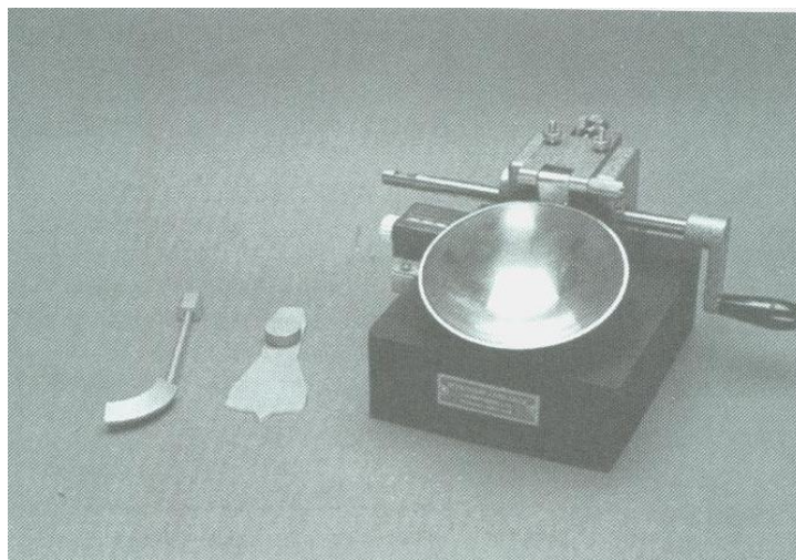
Εικόνα 4 : Μηχανή Casagrande για τον προσδιορισμό του ορίου υδαρότητας
