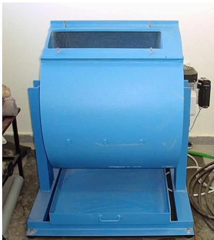
Εικόνα 3 : Μηχανή Los Angeles
