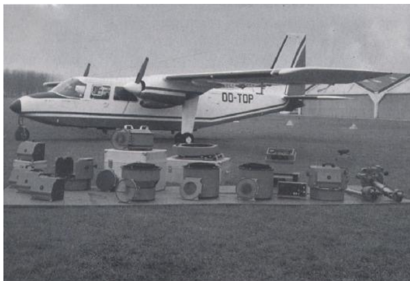
Εικόνα 2. Δικινητήριο αεροπλάνο με φωτογραφικά εξαρτήματα
