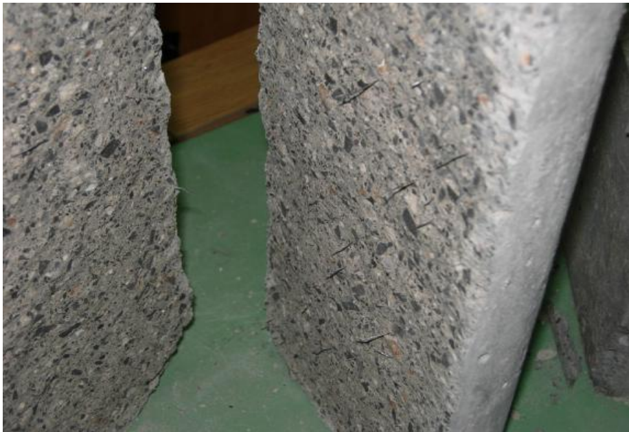
ΕΛΕΓΧΟΣ ΔΟΚΙΜΙΟΥ ΣΕ ΔΙΑΡΡΗΞΗ
