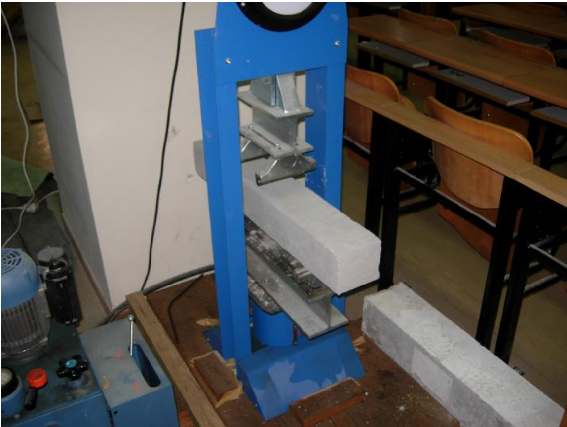
ΠΡΕΣΣΑ ΔΟΚΙΜΗΣ ΣΕ ΚΑΜΨΗ ΤΕΙ ΠΑΤΡΑΣ
