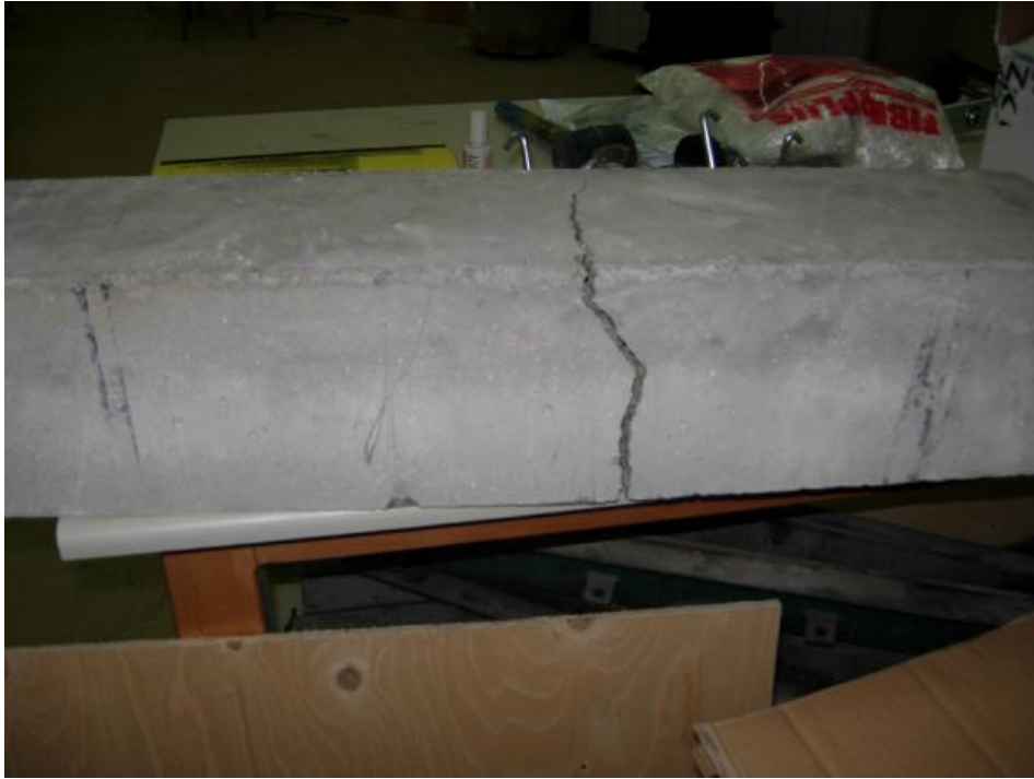
ΕΛΕΓΧΟ ΔΟΚΟΥ 150*150*700 ΧΛΣΤ ΣΕ ΚΑΜΨΗ
