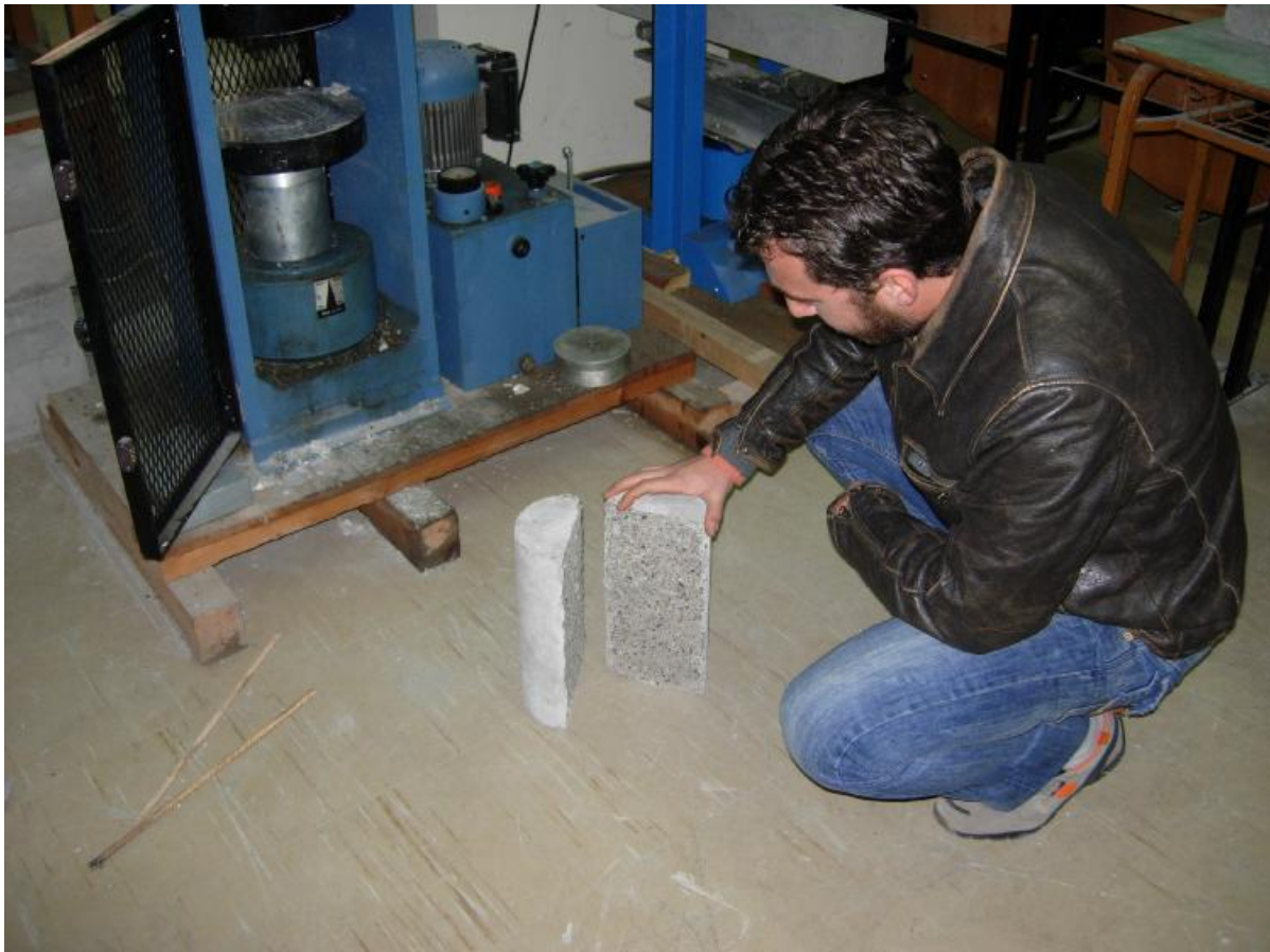
ΕΛΕΓΧΟΣ ΕΠΙΦΑΝΕΙΩΝ ΚΑΤΑ ΤΗΝ ΘΡΑΥΣΗ ΚΑΤΑ ΤΗΝ ΓΕΝΕΤΕΙΡΑ ΤΟΥ ΚΥΛΙΝΔΡΟΥ
