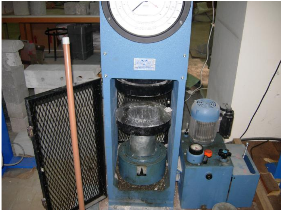
ΠΡΕΣΣΑ ΔΟΚΙΜΗΣ ΣΕ ΘΛΙΨΗ
