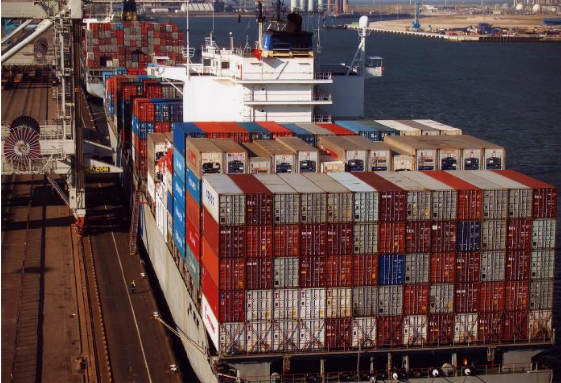
Εικόνα 6: Στοιβάσια Ε/Κ στο κατάστρωμα του πλοίου.
