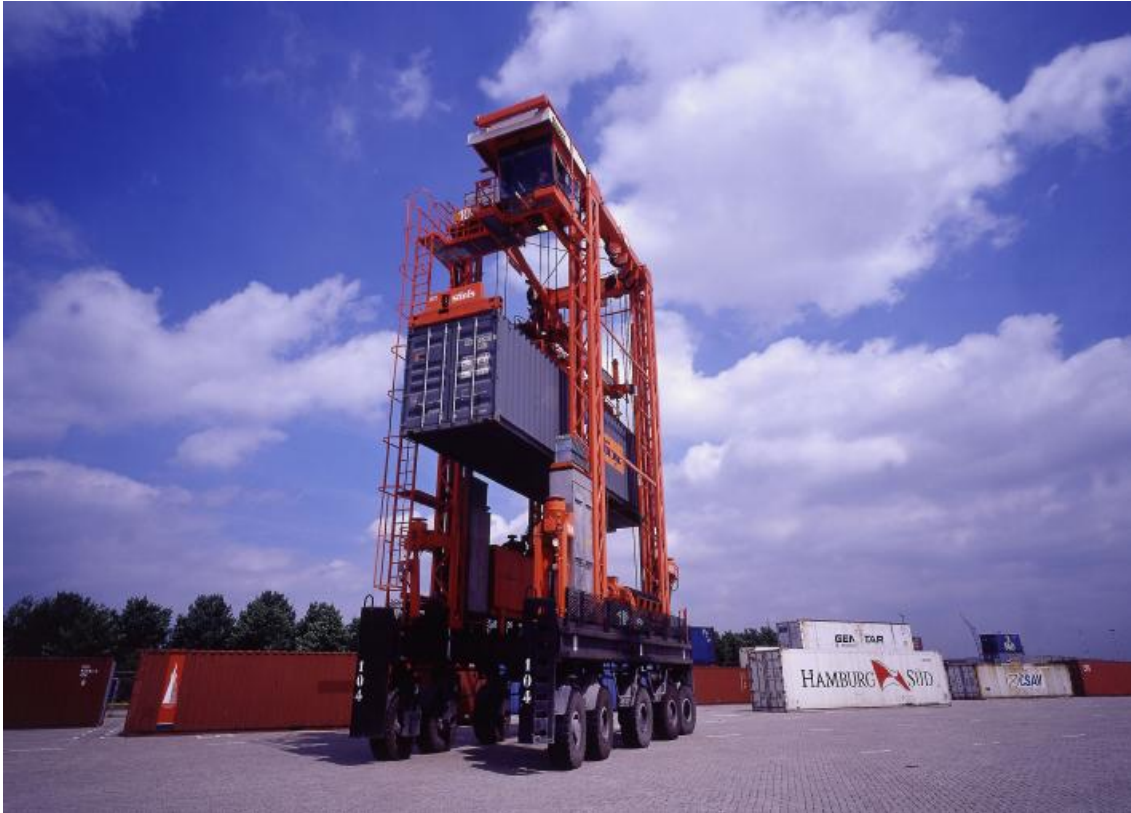
Εικόνα 14: Διαχείριση φορτίου με straddle carrier.
