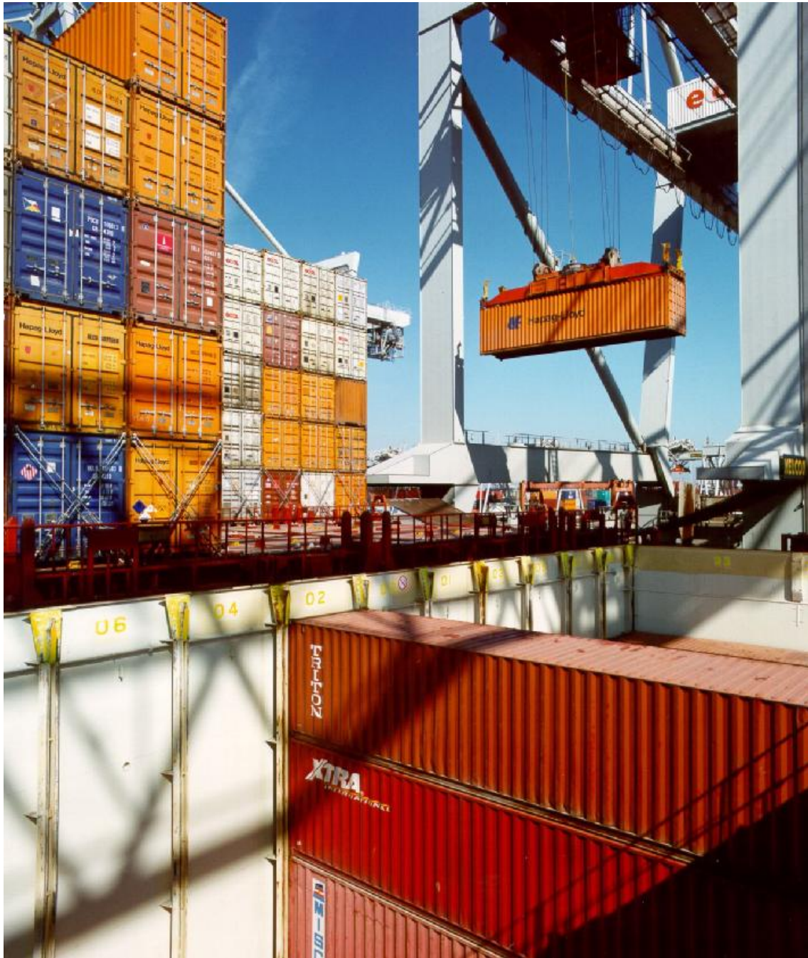
Εικόνα 5: Στοιβάσια Ε/Κ στις κυψέλες εντός του πλοίου.
