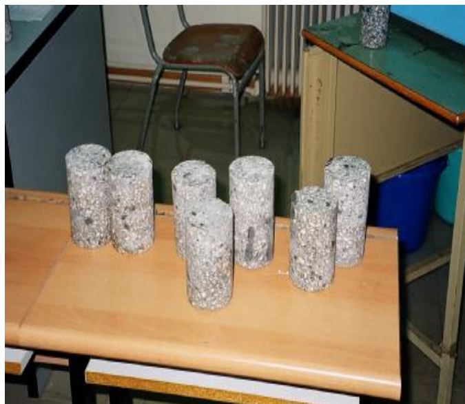
Πυρήνες "κομμένοι" έτοιμοι για την δοκιμή της θλίψης
