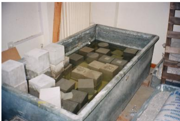
Συντήρηση δοκιμίων σκυροδέματος εντός δεξαμενής
