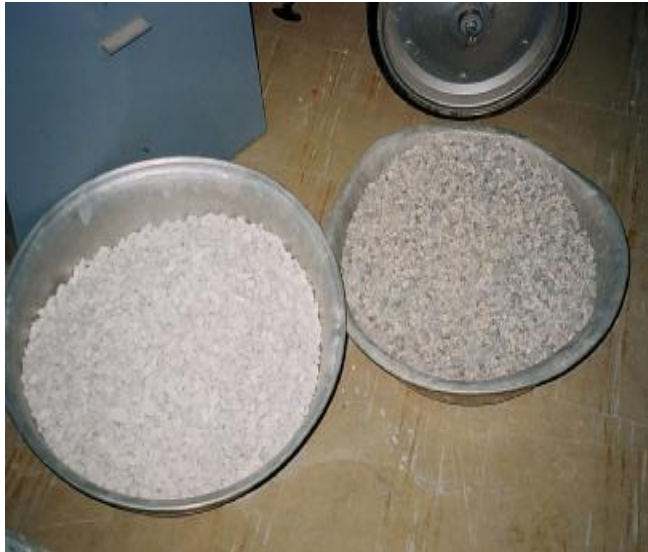
Σκύρα λατομείου που χρησιμοποιήθηκαν για την παρασκευή του σκυροδέματος
