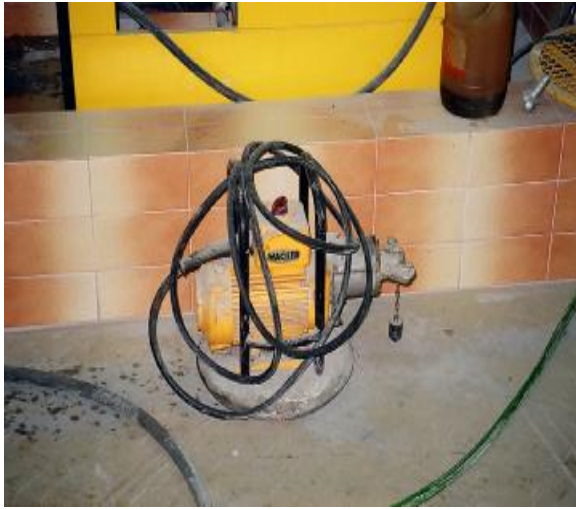
Δονητής μάζας που χρησιμοποιήθηκε κατά την σκυροδέτηση του μοντέλου
