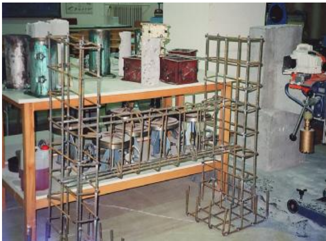
Σιδηρούς οπλισμός κατασκευασθέντος μοντέλου
