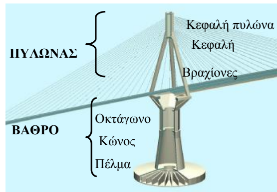
1) Σχήμα 3.3 : Η θεμελίωση και ο πυλώνας της κυρίως γέφυρας
