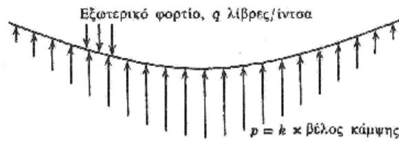
Σχήμα 2.1. Καμπτική παραμόρφωση δοκού πάνω σε ελαστικό υπόστρωμα
