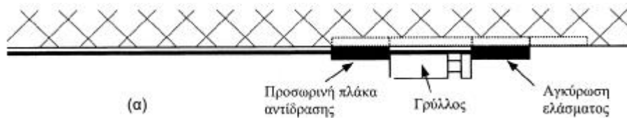
Διάταξη εφαρμογής προέντασης ελάσματος και αγκύρωσης στο άκρο.
