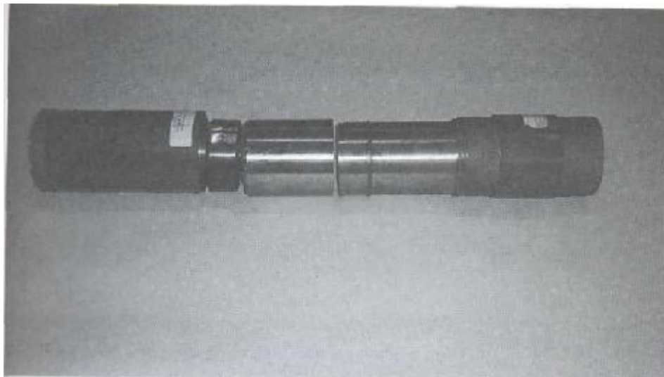
Φωτ. Κοχλίωση κοπτικού άκρου (κορώνας) με τον περικοπήρα.
