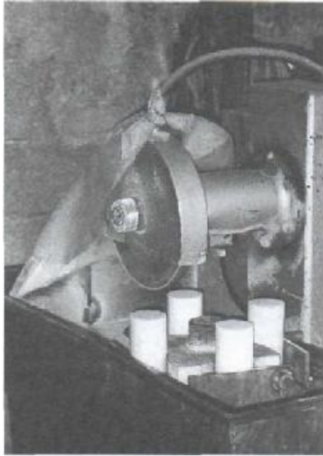
Δίσκος λείανσης βάσεων κυλινδρικών δοκιμίων πετρώματος.
