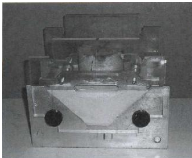
Φωτ. 1 Πλήρωση της μισής μήτρας με ρευστή γύψο.
