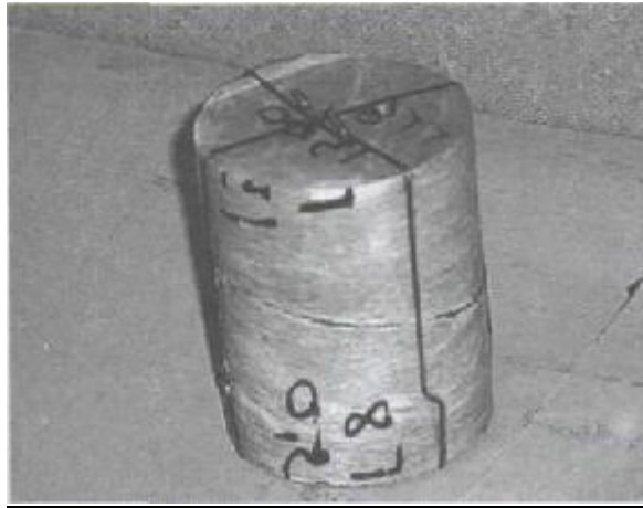
Φωτ. Δοκίμιο βράχου από γεώτρηση που περιέχει ασυνέχεια (διάκλαση) έχει προετοιμαστεί για εγκιβωτισμό (καλούπωμα).
