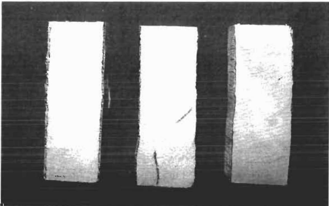
Εικ 6 Σύνθετο έλατο μετά από καταπόνηση σε παράλληλη θλίψη
