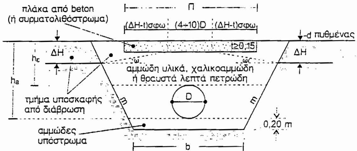
Σχήμα 3.2 Διατομή χωρίς αγκύρια και χωρίς πλάκα προστασίας
