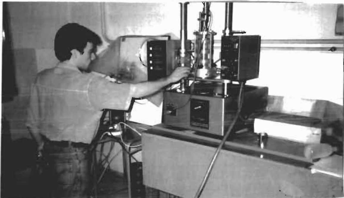
(Φωτ 8 ). Η συσκευή της τριαξονικής δοκιμής του εργαστηρίου εδαφομηχανικής του ΤΕΙ Πάτρας.
