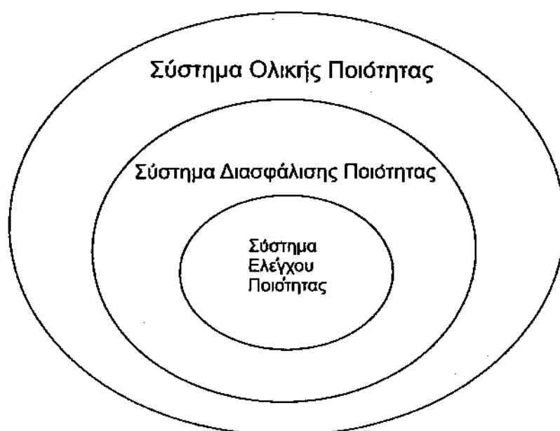
Σχ. 2.13.1.(b). Σχέση μεταξύ Συστήματος Ολικής Ποιότητας, Συστήματος Διασφάλισης Ποιότητας και Συστήματος Ελέγχου Ποιότητας
