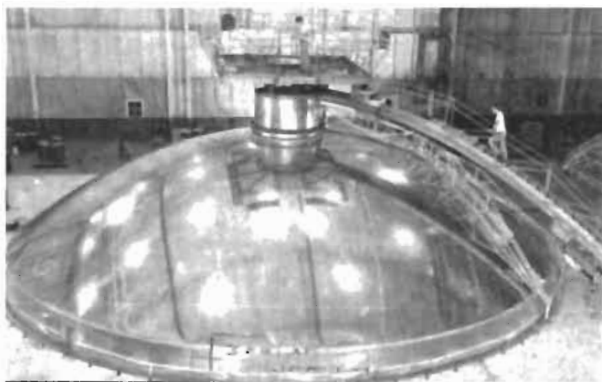
Σχήμα 2.21: Συγκεντρωτικός ηλιακός συλλέκτης της εταιρίας Goodyear Aerospace (ΗΠΑ) για δοκιμές υλικών κατασκευής διαστημόπλοιοιων. [2]
