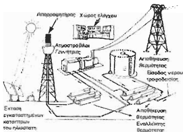
Σχήμα 2.20: Σχηματική παράσταση ηλιακού σταθμού ηλεκτροπαραγωγής. [8]
