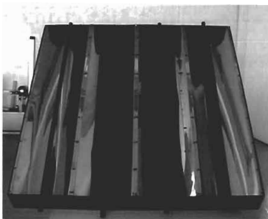
Σχήμα 2.2: Κυλινδρικός παραβολικός συλλέκτης [Εργ. ΗΜΕ]
