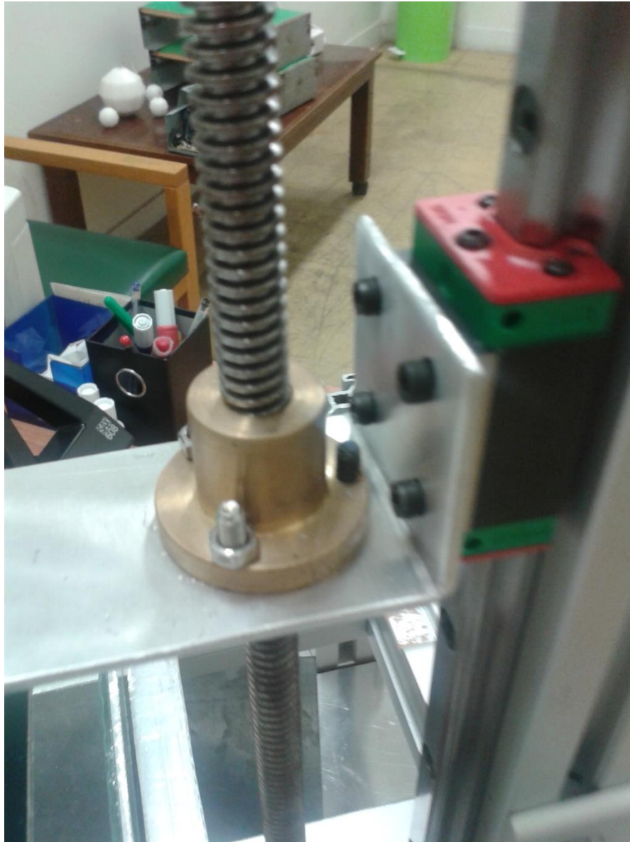
Εικόνα 61. Hiwin HGH 15CA γραμμικό ρουλεμάν
