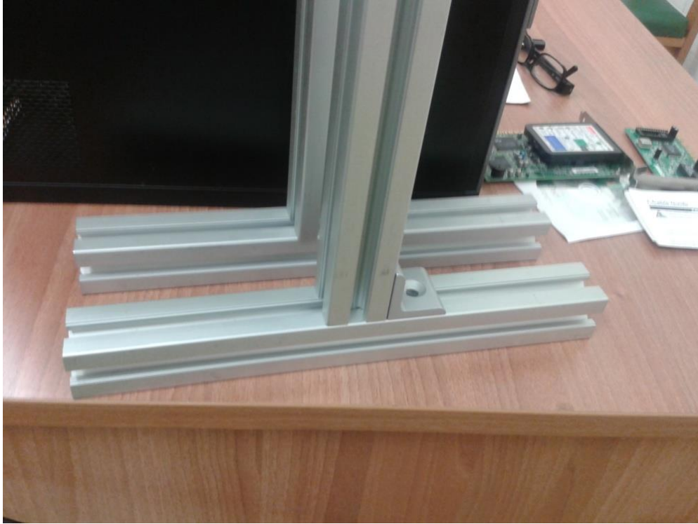
Εικόνα 60. Τοποθέτηση προφίλ αλουμινίου σε σχήμα ανάποδου T.
