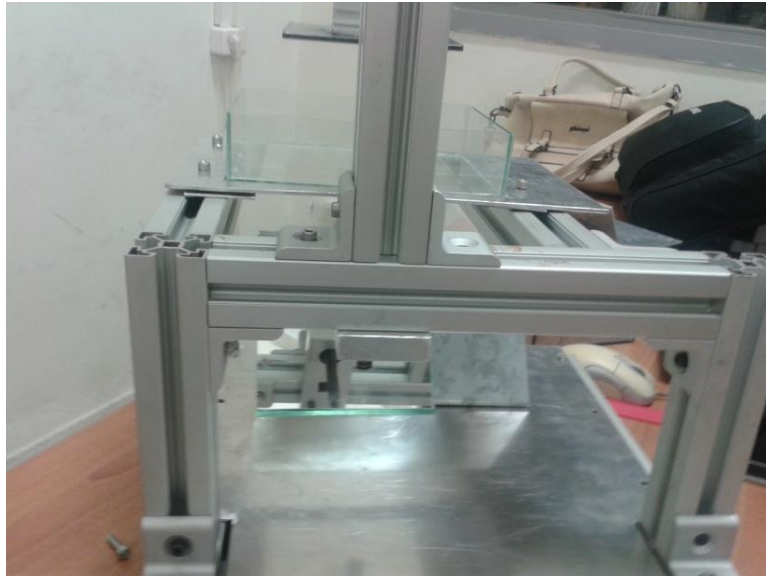
Εικόνα 70. Τοποθέτηση γωνιών σε όλες τις επιθυμητές θέσεις.
