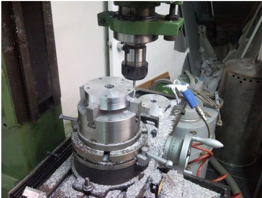
Εικόνα 8: Κατασκευή πρωτοτύπων πολύπλοξης γεωμετρίας με χρήση εργαλειομηχανών C.N.C.
