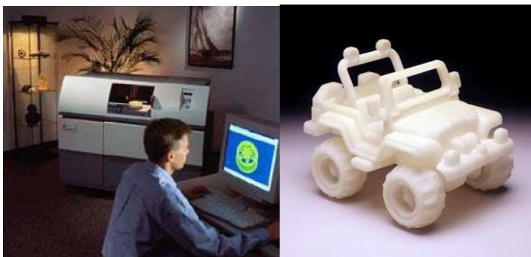
Εικόνα 20: (α) Βιομηχανικού τύπου μηχάνημα SGC, (β) Πρωτότυπο Μοντέλο
