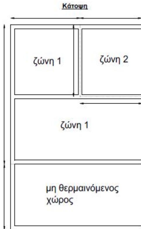
Σχέδιο 2.1: Ορισμός μέτρησης οριζόντιων διαστάσεων (πηγή: TOTEE 20701-1/2010)
