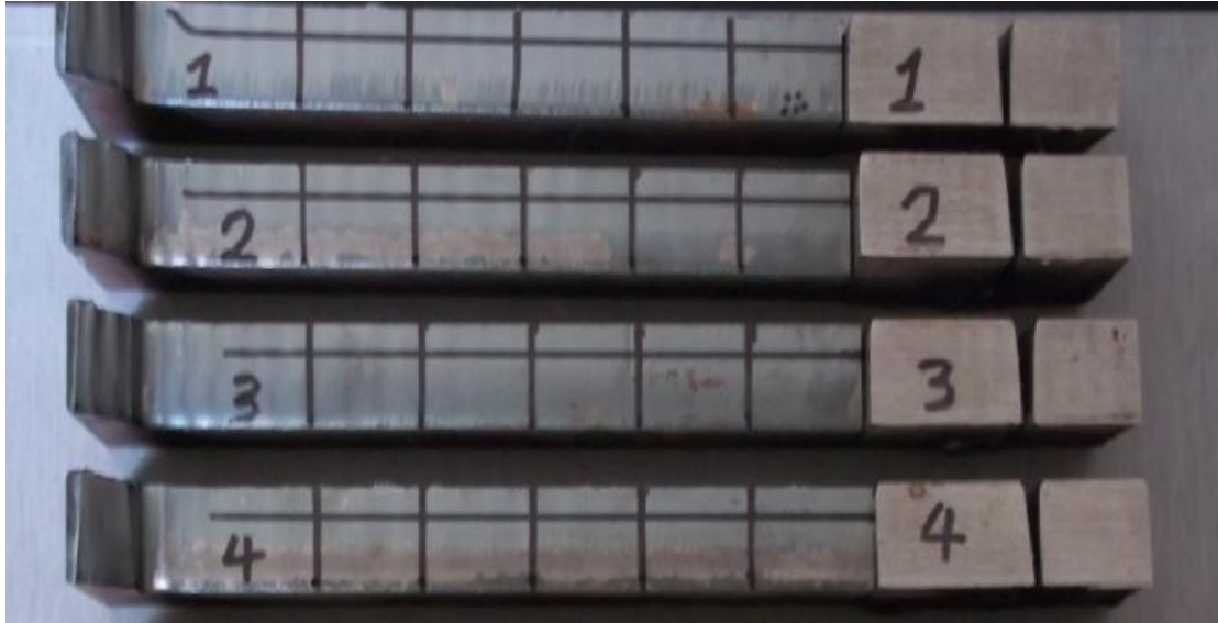
Εικόνα 4.5: (Αριστερά) τμήμα του δοκιμίου το οποίο θα χρησιμοποιηθεί για μέτρηση τραχύτητας. (Δεξιά) τμήμα το οποίο θα χρησιμοποιηθεί για μέτρηση κωνικότητας και HAZ.
