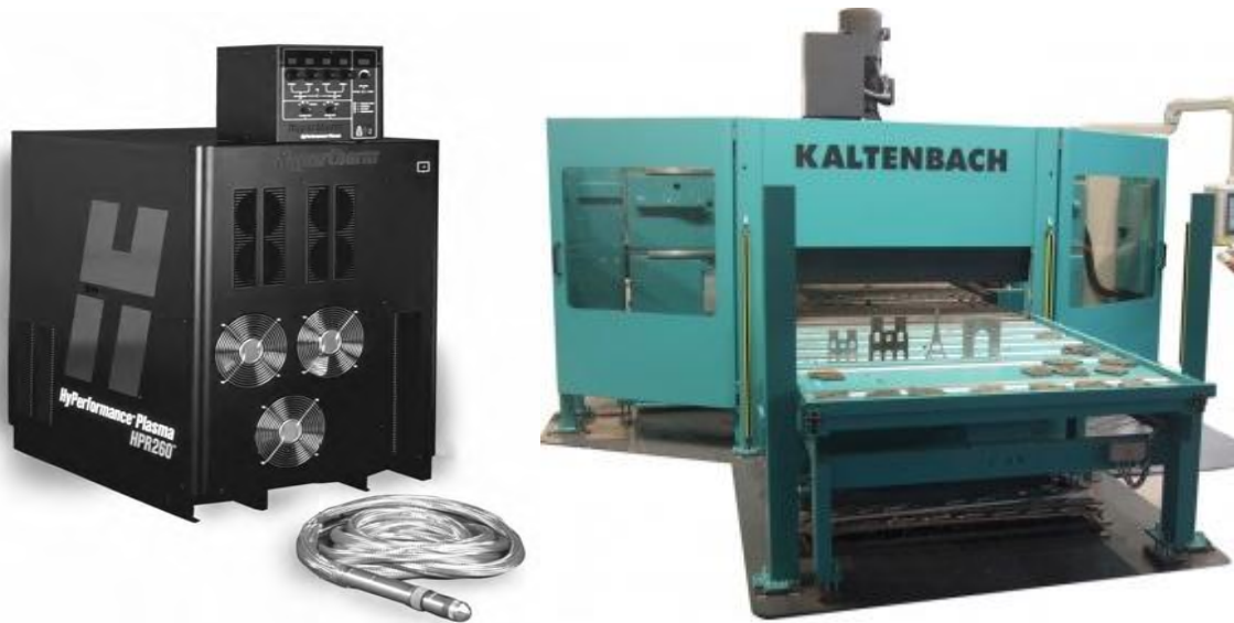
Εικόνα 4.1: Αριστερά μονάδα πλάσματος HPR 260, δεξιά CNC εργαλειομηχανή κατεργασίας φύλλων λαμαρίνα KF 2512.
