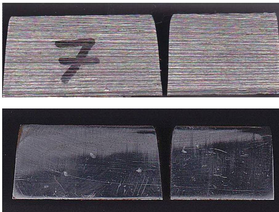
Εικόνα 4.11: Τμήμα δοκιμίου για μέτρηση της Θερμικά επηρεασθείσας περιοχής (haz) πριν την λείανση (επάνω), μετά τη λείανση (κάτω).
