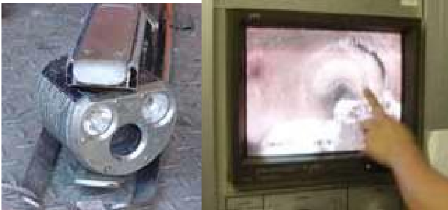
Εικόνα 1 : Η κάμερα με τους προβολείς («rig») και η οθόνη παρατήρησης.
