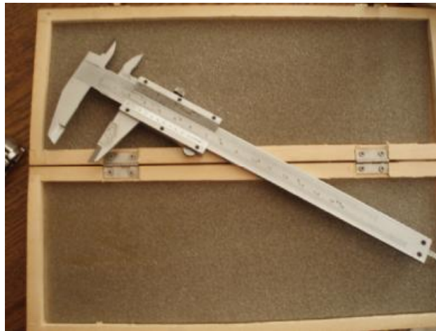
Εικόνα 14: Παχύμετρο (0-150mm) ακρίβειας 0.005mm
