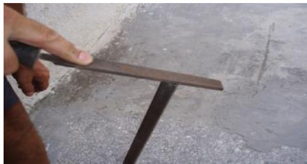
Εικόνα 30: Λείανση με λίμα
