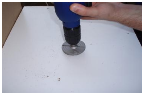
Εικόνα 40: Διάνοιξη οπής με ποτηροτρύπανο
