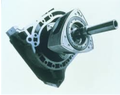
Εικόνα 1.3: Βασικά μέρη του κινητήρα Wankel.
