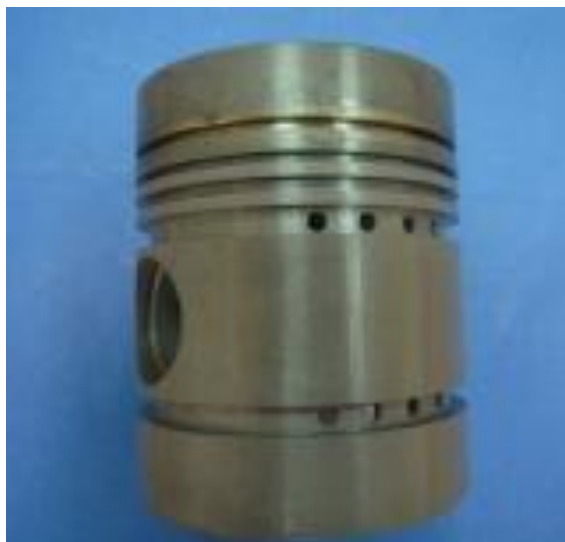
Εικόνα 5.3: Έμβολο πετρελαιομηχανής Perkins παρόμοιο με αυτό που χρησιμοποιήθηκε.
